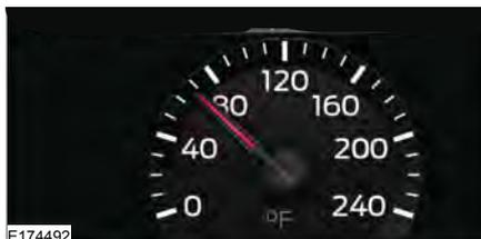
Indique la température de l'air dans le tube d'admission d'air froid.
