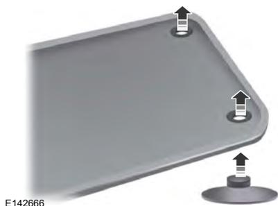
Pour installer le tapis, placez le tapis de façon à ce que l'œillet se trouve sur la tige de fixation et appuyez pour le verrouiller en place.
