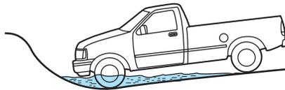
Tras pasar por agua, pruebe siempre los frenos. Los frenos mojados no detienen el vehículo con la eficacia de los frenos secos. Puede secar los frenos más rápido manejando el vehículo lentamente mientras ejerce una leve presión sobre el pedal del freno.
