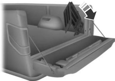
3. Faites pivoter les panneaux en direction du hayon.
