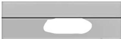
Sur le mur ou sur la surface verticale, vous pouvez observer une bande lumineuse avec une bordure horizontale distincte vers la droite. Si cette bordure n'est pas à la même hauteur que le repère horizontal, le faisceau lumineux doit être réglé en conséquence.
