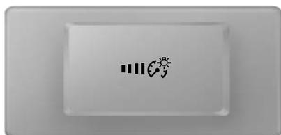
Utilisez le rhéostat d'éclairage de tableau de bord pour régler la luminosité du tableau de bord et de tous les commutateurs appropriés du véhicule lorsque les phares et les feux de position sont allumés.
