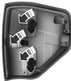
3. Tirez soigneusement sans le tourner le bloc optique hors du montant du hayon vers l'arrière pour dégager les deux éléments de fixation emboîtables dissimulés.
