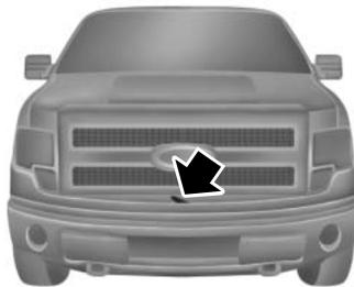
2. Placez-vous devant le véhicule et dégagez le loquet auxiliaire qui se trouve sur le pare-chocs avant, sous la calandre.
