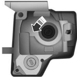
6. Retirez l'ampoule et la douille en la tournant dans le sens contraire des aiguilles d'une montre, puis en les tirant.
