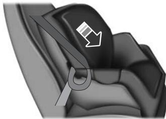
5. Pour placer l'enrouleur en mode de blocage automatique, tirez sur le baudrier vers le bas jusqu'à ce que la sangle soit entièrement déroulée.
