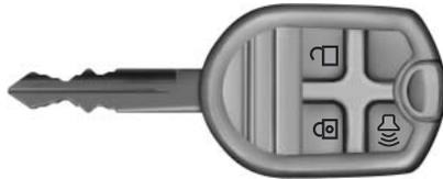
Votre véhicule peut être équipé de deux télécommandes à clé intégrée. Le panneton de clé est utilisé pour démarrer le véhicule et pour déverrouiller ou verrouiller la porte du conducteur depuis l'extérieur du véhicule. La partie télécommande
