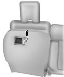
1. Tirez la poignée située au bas du coussin de siège pour déverrouiller le coussin de siège de la position de rangement.
