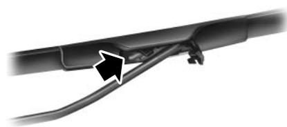
2. Appuyez sur l'agrafe de retenue pour dégager le balai d'essuie-glace, puis tirez le balai vers le bas (C) en direction du pare-brise pour le retirer du bras.
