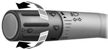
Utilisez la commande rotative pour régler la sensibilité à un des réglages d'intervalle d'humidité. Les essuie-glaces s'activent seulement en cas de détection d'humidité sur le pare-brise. La vitesse des essuie-glaces varie selon la quantité d'humidité détectée sur le
