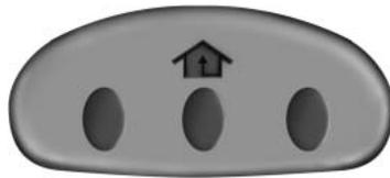
L'ouvre-porte de garage universel remplace l'ouvre-porte de garage portatif classique par une télécommande à deux boutons intégrée au pare-soleil du véhicule.
