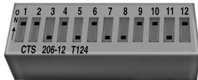
Pour programmer des appareils à code fixe à l'aide des commutateurs DIP, vous aurez besoin de la télécommande de l'ouvre-porte de garage, de papier et d'un crayon ou d'un stylo bille.
