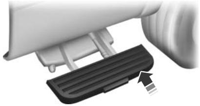
Pour rétracter le marchepied latéral, poussez-le sous le camion avec le pied jusqu'à ce qu'il soit complètement verrouillé. N'appuyez pas sur le bouton pendant la rétraction du marchepied latéral de caisse.
