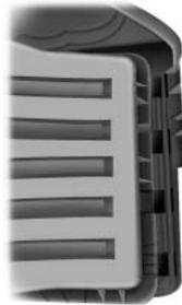
8. Remettez le couvercle du boîtier du filtre en place et fixez les brides. Prenez garde de ne pas coincer les bords de l'élément filtrant entre le boîtier du filtre à air et le couvercle et assurez-vous que les pattes sur le rebord s'alignent avec leurs encoches respectives.
