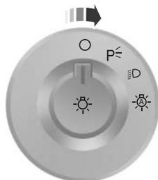
Le système de commande automatique des phares utilise un dispositif photosensible pour régler de façon automatique la mise en fonction et hors fonction des phares normalement commandés par le commutateur d'éclairage.
