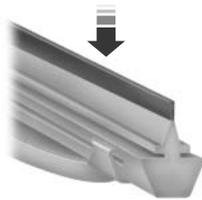
Passez le bout de vos doigts sur le bord du balai pour vérifier la présence de rugosité.
