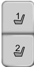
2. Maintenez la touche de programmation **1** (sur le côté du siège du conducteur) enfoncée pendant 5 secondes. Une tonalité retentit après 2 secondes environ. Maintenez la touche enfoncée jusqu'à la deuxième tonalité.
