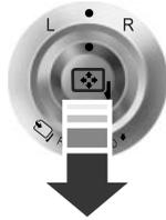
Tirez la commande vers l'arrière pour replier les rétroviseurs vers l'intérieur ou vers l'extérieur.
