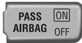
Le détecteur d'occupation du siège passager avant utilise un témoin d'état de sac gonflable du passager qui s'allume pour indiquer que le sac gonflable frontal du passager avant est soit activé (**ON**) ou désactivé (**OFF**). Le témoin se trouve sur la console centrale du tableau de bord.
