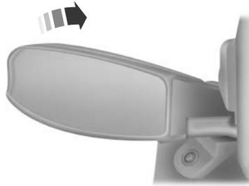
Basculez le coussin de siège vers le haut en le soulevant par le coin jusqu'à ce qu'il s'enclenche en position de rangement verticale.
