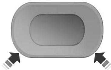
La commande est située sur le côté extérieur du siège. Appuyez sur le côté avant/arrière de la commande pour augmenter ou diminuer le support lombaire.
