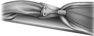
2. Acheminez la sangle de retenue derrière les supports de l'appuie-tête, puis vers une boucle se trouvant derrière une place adjacente et fixez le crochet de la sangle dans la boucle. Du côté passager, acheminez la sangle derrière la fixation du boudin du siège central.
