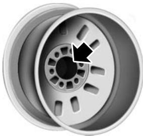
**Nota :** Vérifiez l'avant-trou et la surface de montage de la roue avant la pose. Retirez toute trace de corrosion visible ou de particules détachées.
