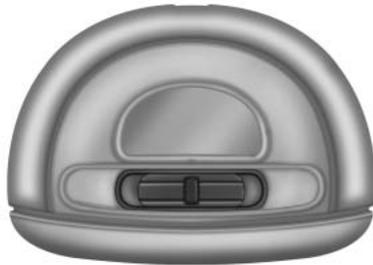
Les feux arrière peuvent être allumés lorsque la commande de rhéostat du panneau est tournée jusqu'à ce que les lampes s'allument ou lorsqu'une porte est ouverte.
