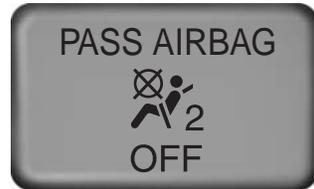
Le capteur de poids du passager avant utilise le témoin de neutralisation du sac gonflable du passager qui s'allume et demeure allumé pour indiquer que le sac gonflable avant du passager avant est neutralisé. Le témoin se trouve sur la console centrale du tableau de bord.
