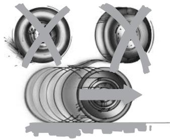
Pour descendre une pente, utilisez le même rapport de vitesse que celui que vous utiliseriez pour la gravir. Vous ménagerez ainsi vos freins qui, autrement, risqueraient de surchauffer. Ne descendez pas au point mort; annulez plutôt la surmultipliée ou rétrogradez manuellement. Durant la descente d'une pente très inclinée, évitez de freiner brusquement puisque cette
