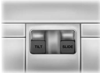
Appuyez brièvement sur la commande **SLIDE** (coulissement) pour ouvrir le toit ouvrant transparent. Le toit ouvrant s'arrêtera juste à court de la position d'ouverture complète.
