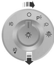
Le commutateur d'éclairage sert également à allumer les phares antibrouillard. Les phares antibrouillards ne peuvent être allumés que lorsque le commutateur d'éclairage est à la position feux de position allumés (seconde position), phares allumés (troisième position), ou phares automatiques (quatrième position) et que les feux de route ne sont pas allumés.
