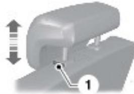
Ziehen, um die Kopfstütze höher einzustellen. Drücken Sie die Verriegelungstaste 1, um die Kopfstütze tiefer einzustellen oder um die Kopfstütze zu entfernen.
