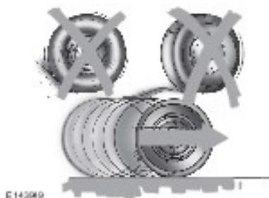
Fahren Sie eine Steigung mit dem gleichen Gang hinab, den Sie zum Hochfahren einlegen würden, um übermäßige Bremsenbeanspruchung und Bremsenüberhitzung zu vermeiden. Fahren Sie keinesfalls im Leerlauf hinunter. Schalten Sie den Overdrive aus oder legen Sie mit dem Getriebewählhebel einen niedrigeren Gang ein. Beim Herunterfahren von steilen Abhängen scharfes Bremsen vermeiden, da Sie die Fahrzeugkontrolle verlieren könnten. Die Vorderräder müssen sich drehen, um Ihr Fahrzeug lenken zu können.
