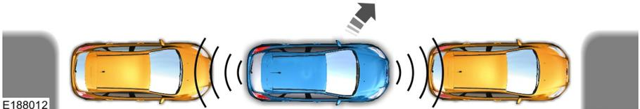
Das System ermittelt den Abstand vor und hinter Ihrem Fahrzeug und lenkt Ihr Fahrzeug (ohne Zutun des Fahrers) automatisch aus der parallelen Parklücke, während Sie das Gaspedal, den Schalthebel und die Bremse betätigen. Das System leitet Sie visuell und akustisch, um in den Verkehrsfluss einzufahren.
