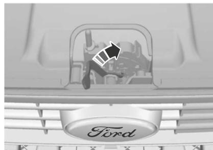
Soulever légèrement le capot et déplacer le crochet vers le côté gauche du véhicule.
