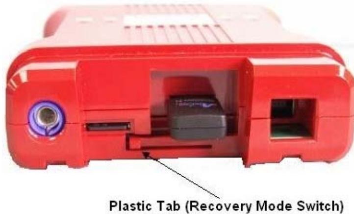
FIGURE 6: VUE DE L'EXTRÉMITÉ DU MODULE VCM II MONTRANT L'INTERRUPTEUR DE MODE DE RÉCUPÉRATION
