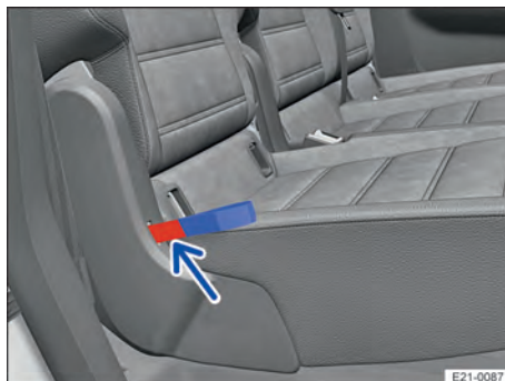
Bilde 67 Andre seterad: Merke for seterygg som ikke er gått i lås.
