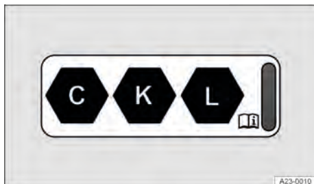
Bilde 163 På ladekontakten: Klistremerke for AC-lading (C) og DC-lading (K, L) med spenning på inntil 920 volt.
