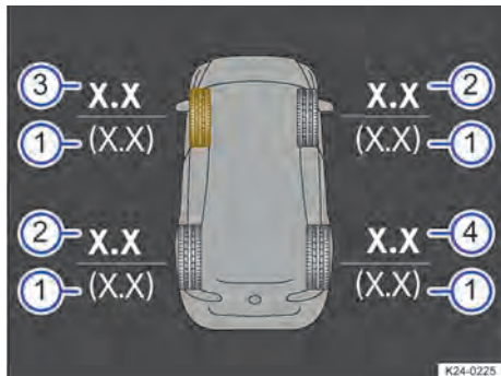
Bilde 220 Displayvisning i infotainmentsystemet: Faktiske dekktrykk (eksempel).
