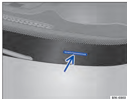
Bilde 274 I frontruten: Bilens identifikasjonsnummer.
