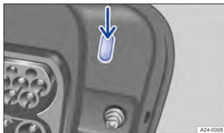
Bilde 166 Bak batteriladeluken: Ladeindikator.
