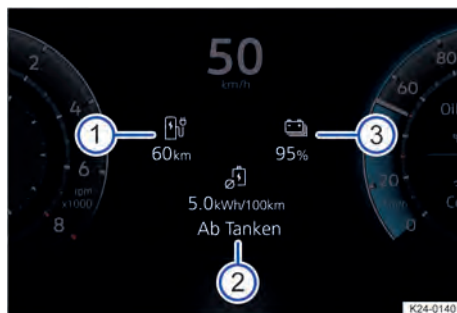
Bilde 15 I hovedvisningsområdet til den digitale instrumentgruppen: Ladenivå og rekkevidde (eksempel).
