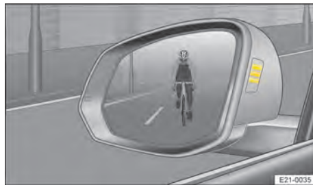
Bilde 115 I sidespeilhuset: Visning fra utstigningsvarslingen (eksempel).
