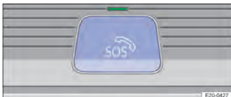
Bilde 49 I takkonsollen: Tast for nødansropstjenesten eCall (bak tastedekslet).
