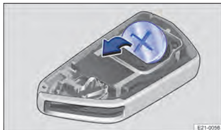
Bilde 54 Bilnøkkel: Skifte batteri.
