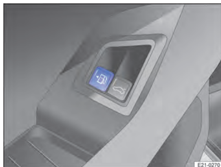
Bilde 159 I førerdøren: Tast for å låse opp tankklaffen (eksempel).
