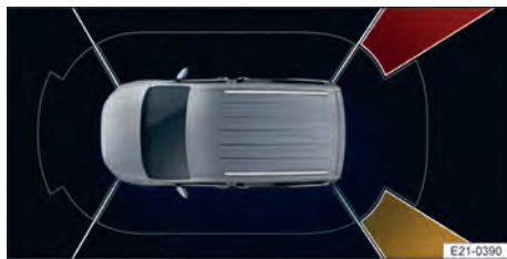
Bilde 130 Infotainmentsystem: Visning av advarsel om kryssende trafikk.
