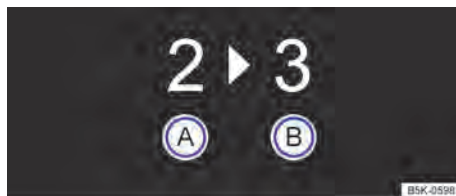
Bilde 99 På displayet i instrumentgruppen: Giranbefaling.
