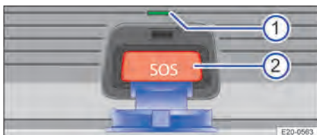
Bilde 50 Betjeningsselement for nødansrop: Kontrollampe og tast for nødansropstjenesten eCall.
