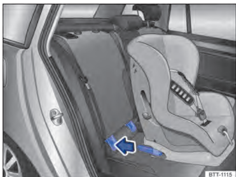
Bilde 41 Montere barnesete med låsearmene (eksempel).
