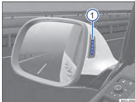
Bilde 113 I sidespeilhusene: Optisk visning for blindsone-assistenten.
