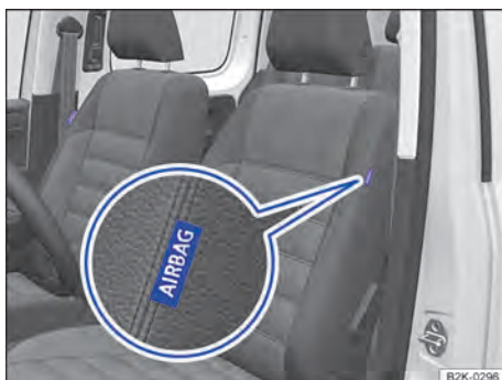
Bilde 34 På siden av forsetet: Plassering av sidekollisjonsputen.
