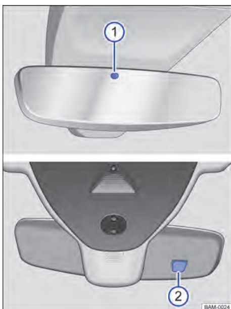
Bilde 88 På frontruten: Automatisk avblendbart innvendig speil.
