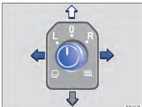
Bilde 90 I førerdøren: Dreieknott for sidespeilene.
