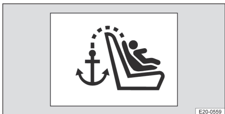
Bilde 42 Eksempel: Merking av Top Tether-fester.
