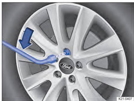
Bilde 225 Løsne hjulboltene.
