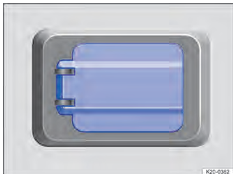
Bilde 135 På midtkonsollen bak eller på skilleveggen til lasterommet: Jordet 230-voltstikkontakt som kan vippes opp (eksempel).
