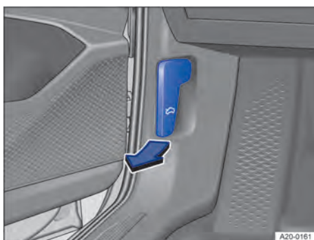
Bilde 202 Ved gulvet på venstre side: Hendel for å låse opp panseret (eksempel).
