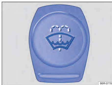
Bilde 207 I motorrommet: Løkk på spylervæskebeholderen (eksempel).
