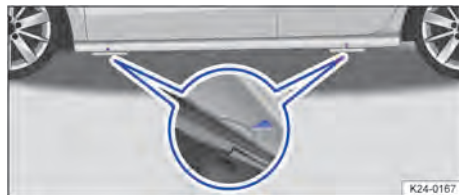
Bilde 226 På kanalen: Merking av festepunktene for jekken.
