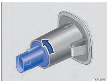
Bilde 184 Skifte lyspære i sideblinklyset.
