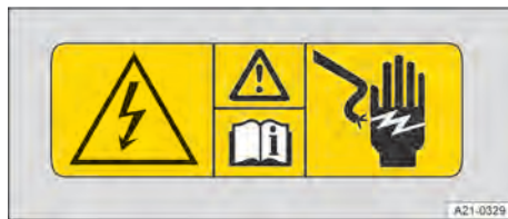
Bilde 161 Varselskilt i frontrummet.
