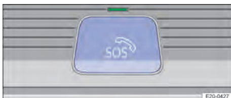
Bilde 47 I takkonsollen: Tast for nødanropstjeneste (eCall) (bak tastedekslet) og kontrollampe.
