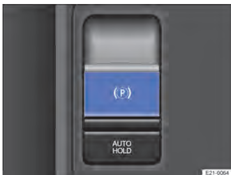
Bilde 114 I midtkonsollen: Tast for parkeringsbremsen (eksempel).
