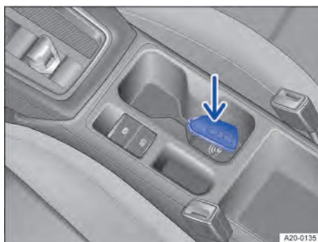
Bilde 95 I midtkonsollen: Nødstartfunksjon.
