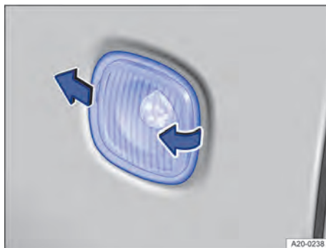
Bilde 183 På siden av bilen: Utmontere sideblinklys.
