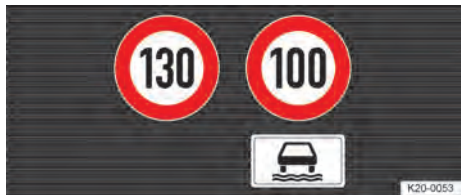
Bilde 26 På displayet i instrumentgruppen: Visning av trafikkskiltgjenkjenning med gjenkjent tilleggsskilt (eksempel).
