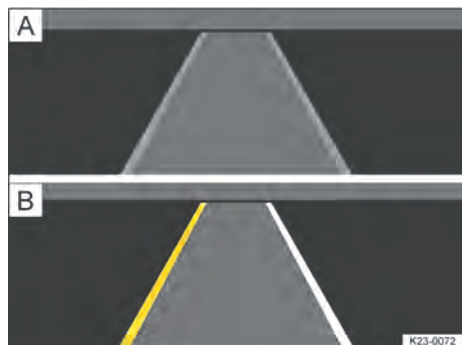
Bilde 110 På displayet i instrumentgruppen: Displayvisninger for filskiftevarslingen (eksempel).
