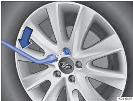
Abb. 219 Radwechsel: Radschrauben mit dem Radschlüssel abschrauben.
