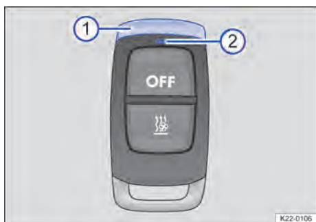
Abb. 94 Funkfernbedienung für die Standheizung.
