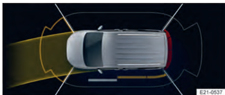
Abb. 126 Im Infotainment-System: Hinderniserkennung und Lenkeinschlag der Parksensoren (Prinzipdarstellung).
