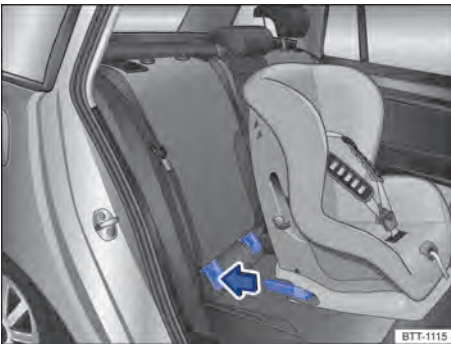
Abb. 43 Prinzipdarstellung: ISOFIX-Kindersitz mit Rastarmen einbauen.
