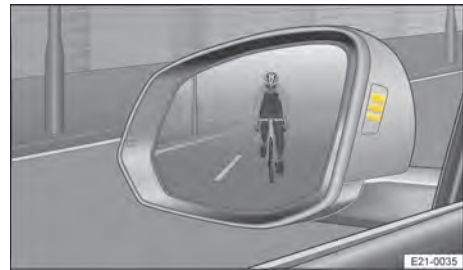
Abb. 124 Im Gehäuse der Außenspiegel: optische Anzeige der Ausstiegswarnung.
