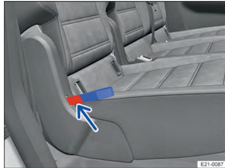
Abb. 66 Zweite Sitzreihe: Markierung für nicht sicher eingerastete Sitzlehne.
