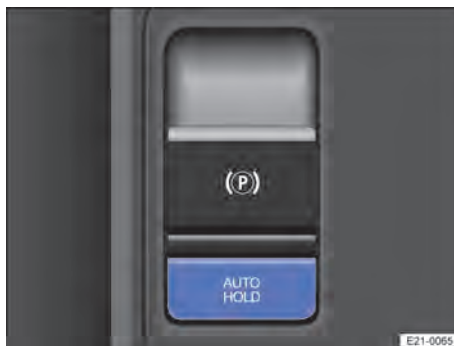
Abb. 125 In der Mittelkonsole: Taste für Auto Hold.
