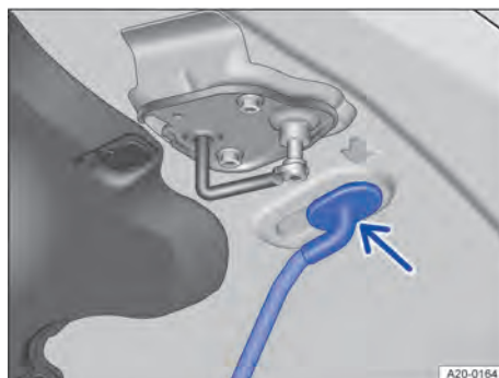
Abb. 195 An der Frontklappe: Aufnahme für die Klappenstütze.
