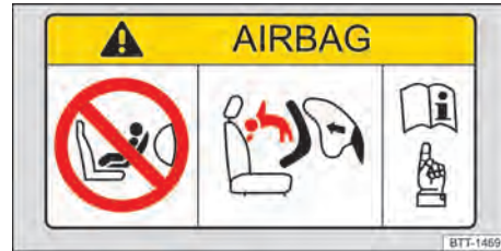
Abb. 39 Prinzipdarstellung: Airbag-Label an der Sonnenblende.
