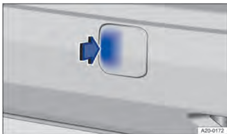
Abb. 188 Im Stoßfänger hinten rechts: Abdeckung abnehmen.
