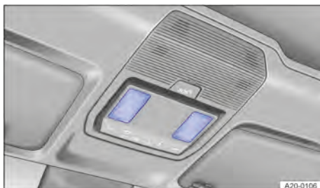
Abb. 85 In der Dachkonsole: Berührungssensitive Leseleuchten.
