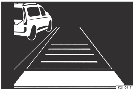
Abb. 110 Im Display des Kombiinstrumentes: Langsameres Fahrzeug auf der linken Spur erkannt (Prinzipdarstellung).
