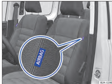
Abb. 34 Seitlich im Vordersitz: Einbauort des Seitenairbags.
