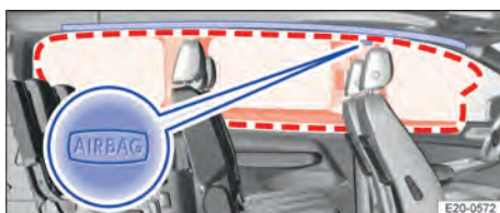
Abb. 36 Auf der linken Fahrzeugseite: Einbauort und Entfaltungsbereich des Kopfairbags (7-Sitzer).
