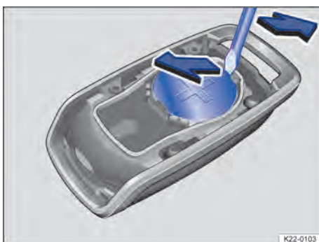
Abb. 96 Funkfernbedienung: Knopfzelle wechseln.
