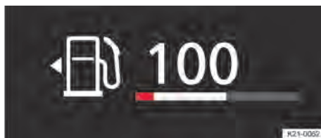
Abb. 15 Kraftstoffvorratsanzeige im digitalen Kombiinstrument (Prinzipdarstellung).
