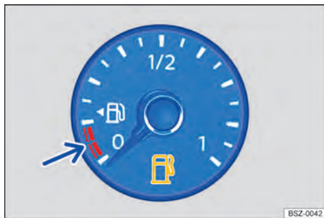
Abb. 16 Kraftstoffvorratsanzeige im analogen Kombiinstrument (Prinzipdarstellung).
