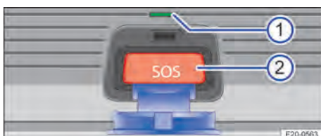
Abb. 50 Bedienelement für Notruf: Kontrollleuchte und Taste.
