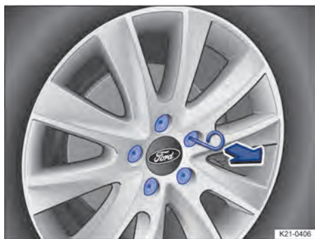
Abb. 213 Abdeckkappen von den Radschrauben abziehen.
