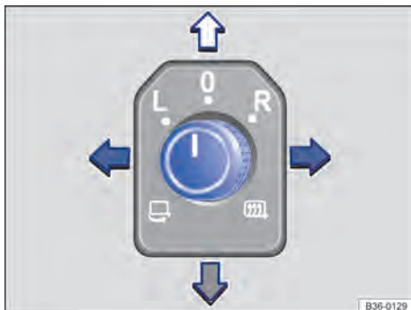
Abb. 91 In der Fahrertür: Drehknopf für die Außenspiegel.
