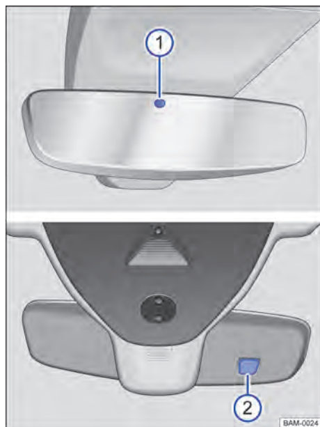
Abb. 89 An der Frontscheibe: Automatisch abblendender Innenspiegel.
