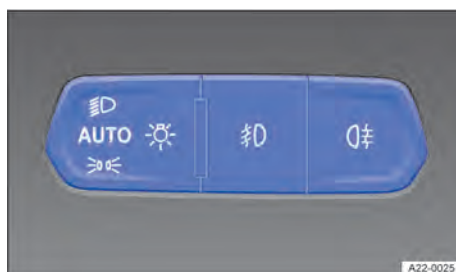
Abb. 82 Neben dem Lenkrad: Bedienfeld zum Einschalten der Außenbeleuchtung.
