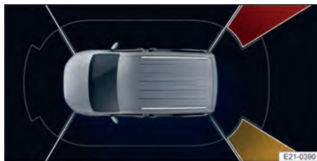
Abb. 140 Im Bildschirm des Infotainment-Systems: Anzeige der Querverkehrswarnung.
