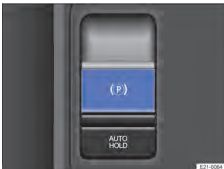
Abb. 122 In der Mittelkonsole: Taste für die Parkbremse.
