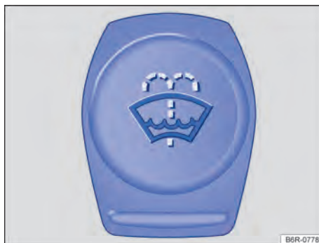
Abb. 197 Im Motorraum: Deckel des Scheibenwaschwasserbehälters.
