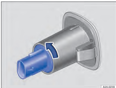
Abb. 178 Glühlampe des Seitenblinklichts wechseln.
