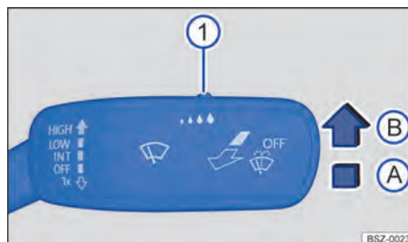
Abb. 88 An der Lenksäule rechts: Scheibenwischerhebel.
