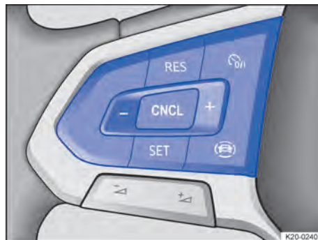
Abb. 108 Linke Seite des Multifunktionslenkrads.
