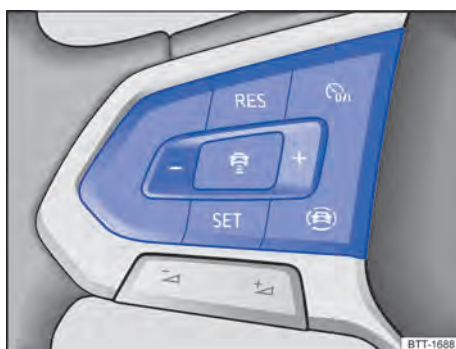
Abb. 115 Linke Seite des Multifunktionslenkrads.
