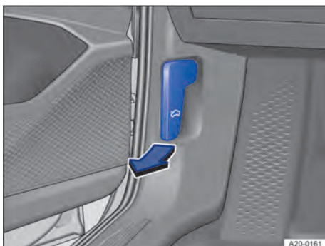
Abb. 192 Im Fußraum links: Entriegelungshebel für die Frontklappe (Prinzipdarstellung).
