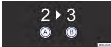
Abb. 105 Im Display des Kombi-Instruments: Gangempfehlung.
