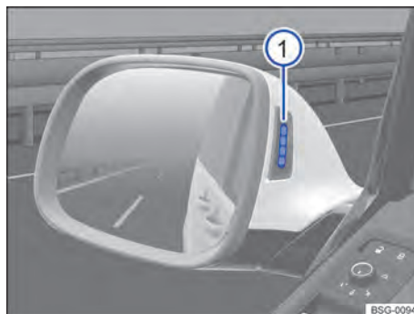
Abb. 121 Im Gehäuse der Außenspiegel: Optische Anzeigen des Spurwechselwarners.
