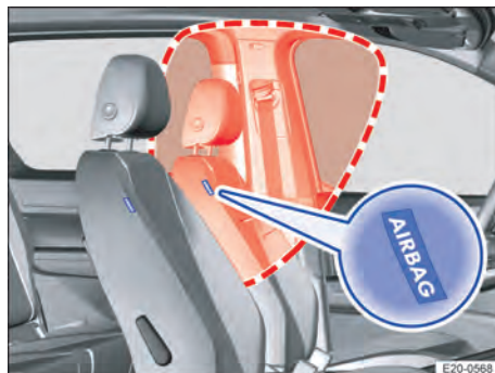
Abb. 37 Im inneren Sitzlehnenpolster des Fahrersitzes: Center-Airbag.
