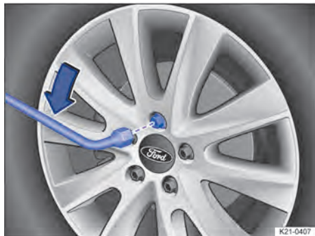
Abb. 214 Radwechsel: Radschrauben lockern.
