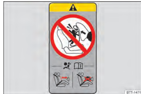
Abb. 40 Prinzipdarstellung: Airbag-Label an der B-Säule.
