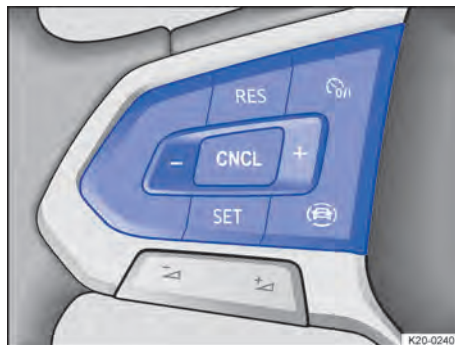
Abb. 107 Linke Seite des Multifunktionslenkrads.
