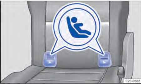
Abb. 42 Am Fahrzeugsitz dritte Sitzreihe: Kennzeichnungsvarianten der ISOFIX-Verankerungspunkte für Kindersitze.
