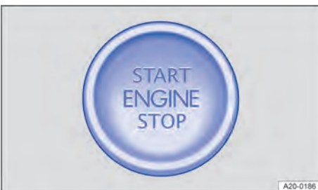
Abb. 100 Im unteren Teil der Mittelkonsole: Startknopf zum Anlassen des Motors.
