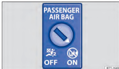
Abb. 30 An der Stirnseite der Instrumententafel: Schlüsselschalter zum Aus- und Einschalten des Beifahrer-Frontairbags.
