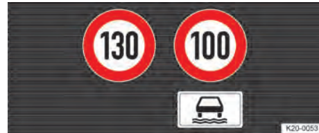
Abb. 19 Im Display des Kombiinstruments: Beispiele für erkannte Geschwindigkeitsgebote mit den zugehörigen Zusatzschildern.
