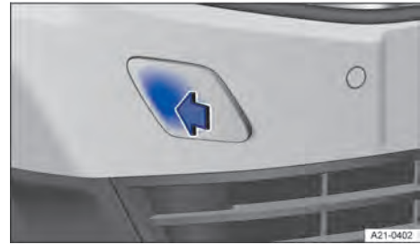
Abb. 190 Im Stoßfänger vorn rechts: Abdeckung abnehmen.
