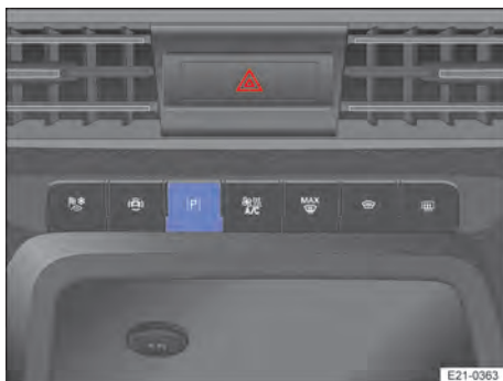
Abb. 127 In der Mittelkonsole: Bedienfeld für Parkfunktionen.
