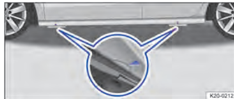
Abb. 216 Aufnahmepunkte für den Wagenheber.
