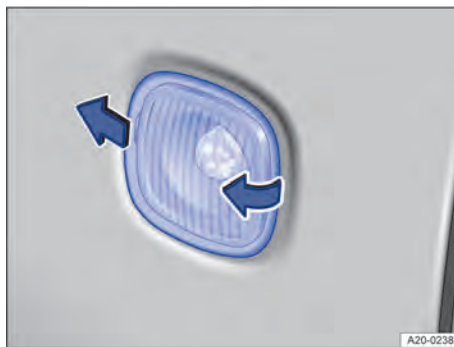
Abb. 177 An der Fahrzeugseite: Seitenblinklicht ausbauen.
