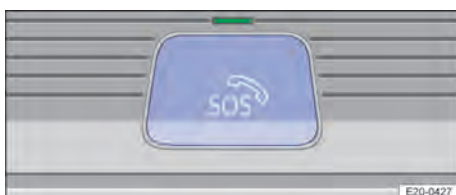
Abb. 49 In der Dachkonsole: Bedienelement für Notrufsystem eCall (hinter Tastenabdeckung).
