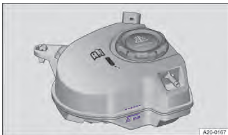
Abb. 201 Im Motorraum: Markierung an dem Motorkühlmittelausgleichsbehälter (Prinzipdarstellung).
