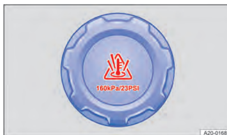
Abb. 200 Im Motorraum: Deckel des Motorkühlmittelausgleichsbehälters.
