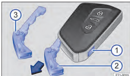
Abb. 51 Fahrzeugschlüssel: Entriegelung des Notschlüssels.
