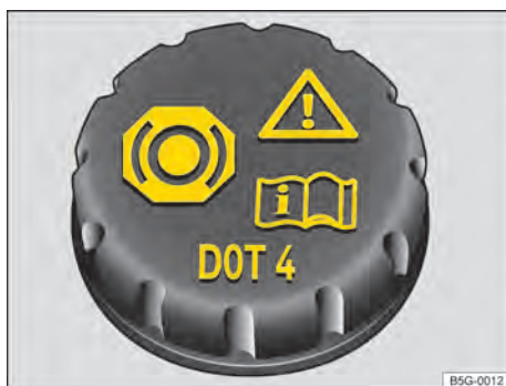
Abb. 202 Im Motorraum: Deckel des Bremsflüssigkeitsbehälters.
