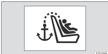
Abb. 44 Prinzipdarstellung: Kennzeichnung für Top Tether Befestigungspunkt
