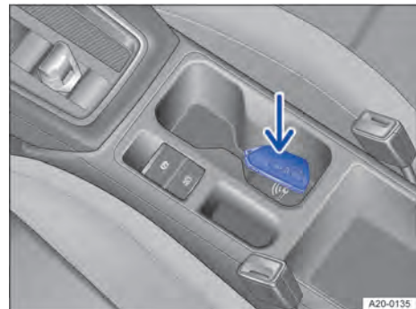
Abb. 101 In der Mittelkonsole: Notstartfunktion.
