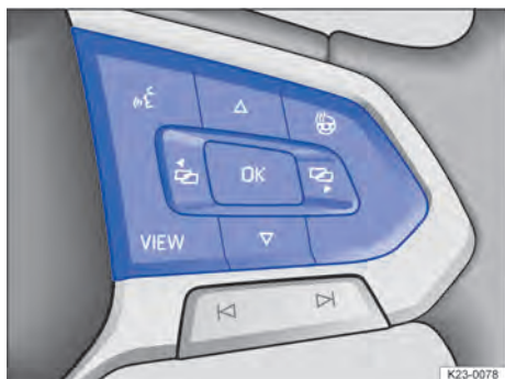
Abb. 13 Rechte Seite des Multifunktionslenkrads: Digitales Kombiinstrument bedienen (Prinzipdarstellung).
