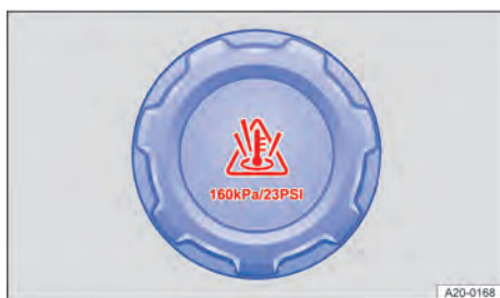
Abb. 207 Im Frontraum: Deckel des Kühlmittelbehälters.
