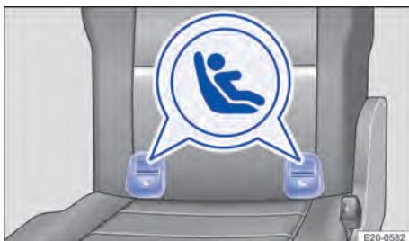
Abb. 43 Am Fahrzeugsitz dritte Sitzreihe: Kennzeichnungsvarianten der ISOFIX-Verankerungspunkte für Kindersitze.
