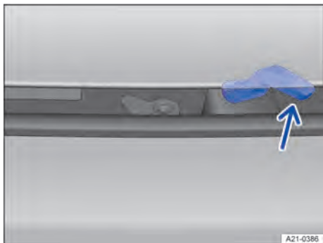
Abb. 200 Über dem Kühlergrill: Öffnungshebel für die Frontklappe.
