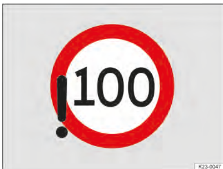
Abb. 19 Im Display des Kombi-instruments: Erkannte Überschreitung der zulässigen Höchstgeschwindigkeit (Prinzipdarstellung).
