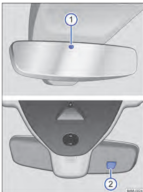
Abb. 93 An der Frontscheibe: Automatisch abblendender Innenspiegel.
