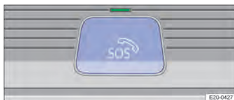
Abb. 50 In der Dachkonsole: Bedienelement für Notrufsystem eCall (hinter Tastenabdeckung).
