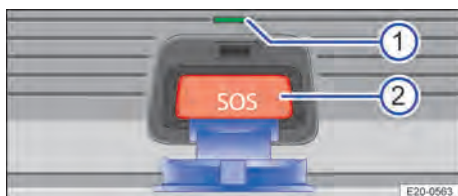
Abb. 51 Bedienelement für Notruf: Kontrollleuchte und Taste.
