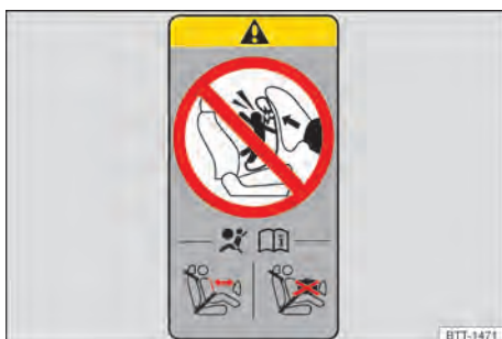
Abb. 41 Prinzipdarstellung: Airbag-Label an der B-Säule.
