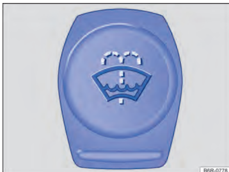
Abb. 204 Im Motorraum: Deckel des Scheibenwaschwasserbehälters.
