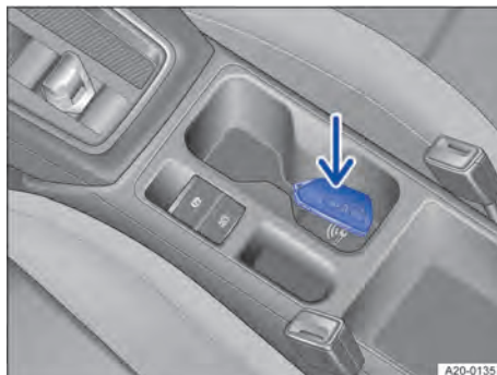
Abb. 104 In der Mittelkonsole: Notstartfunktion.
