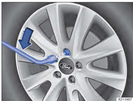
Abb. 225 Radschrauben mit dem Radschlüssel abschrauben.
