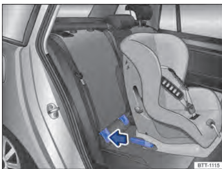
Abb. 44 Prinzipdarstellung: ISOFIX-Kindersitz mit Rastarmen einbauen.
