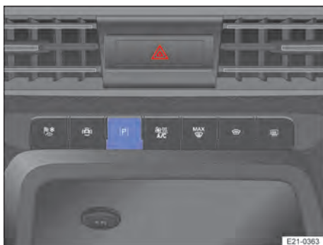
Abb. 127 In der Mittelkonsole: Bedienfeld für Parkfunktionen.
