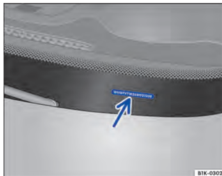
Abb. 267 In der Frontscheibe: Fahrzeug-Identifizierungsnummer.
