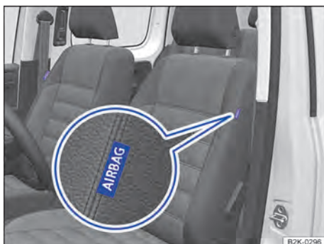
Abb. 34 Seitlich im Vordersitz: Einbauort des Seitenairbags.
