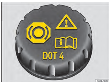
Abb. 209 Im Motorraum: Deckel des Bremsflüssigkeitsbehälters.
