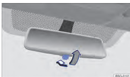
Abb. 94 An der Frontscheibe: Manuell abblendbarer Innenspiegel.
