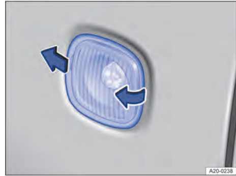
Abb. 184 An der Fahrzeugseite: Seitenblinklicht ausbauen.
