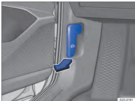
Abb. 199 Im Fußraum links: Entriegelungshebel für die Frontklappe (Prinzipdarstellung).
