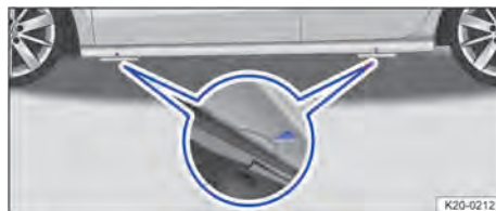
Abb. 222 Am Seitenschweller: Markierungen für die Aufnahmepunkte des Wagenhebers.
