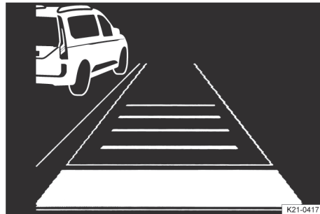
Abb. 115 Im Display des Kombiinstrumentes: Langsames Fahrzeug auf der linken Spur erkannt (Prinzipdarstellung).
