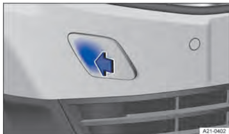
Abb. 197 Im Stoßfänger vorn rechts: Abdeckung abnehmen.
