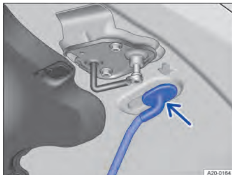
Abb. 202 An der Frontklappe: Aufnahme für die Klappenstütze.
