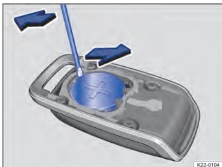
Abb. 99 Funkfernbedienung: Knopfzelle wechseln.
