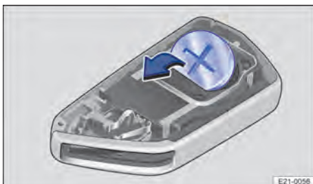
Abb. 55 Fahrzeugschlüssel: Knopfzelle wechseln.
