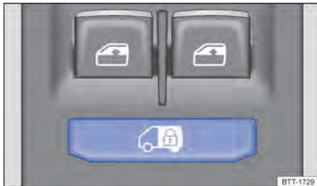
Abb. 59 In der Fahrertür: Taste zum Verriegeln des Laderaums.
