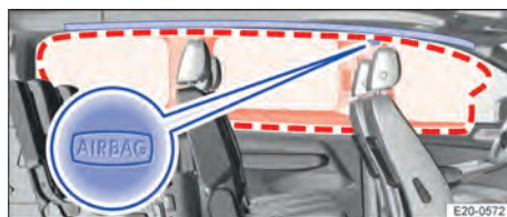
Abb. 37 Auf der linken Fahrzeugseite: Einbauort und Entfaltungsbereich des Kopfairbags (7-Sitzer).
