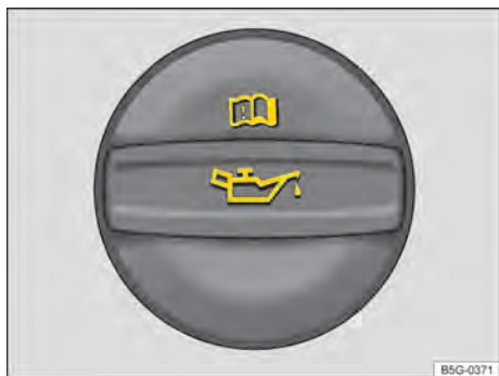
Abb. 206 Im Motorraum: Deckel der Motoröleinfüllöffnung (Prinzipdarstellung).
