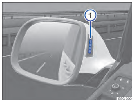
Abb. 122 Im Gehäuse der Außenspiegel: Optische Anzeigen des Spurwechselwarners.
