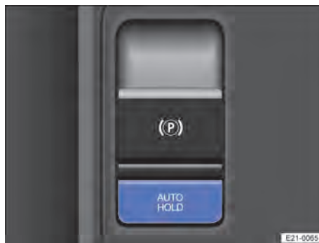
Abb. 125 In der Mittelkonsole: Taste für Auto Hold.
