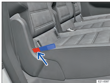
Abb. 70 Zweite Sitzreihe: Markierung für nicht sicher eingerastete Sitzlehne.
