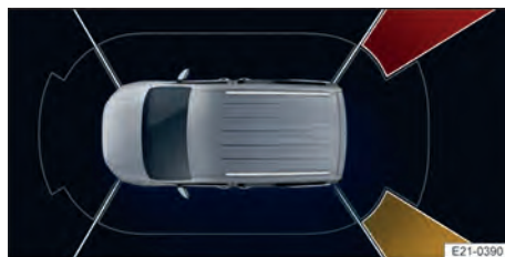
Abb. 140 Im Bildschirm des Infotainment-Systems: Anzeige der Querverkehrswarnung.
