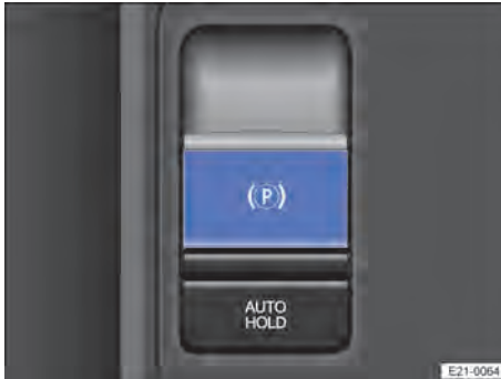
Abb. 123 In der Mittelkonsole: Taste für die Parkbremse.
