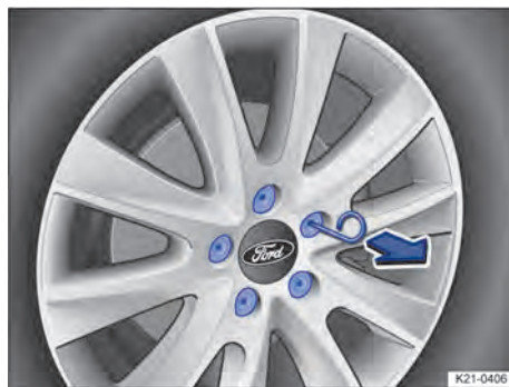
Abb. 220 Abdeckkappen von den Radschrauben abziehen.
