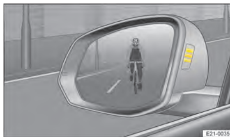
Abb. 124 Im Gehäuse der Außenspiegel: Anzeige der Ausstiegswarnung (Prinzipdarstellung).
