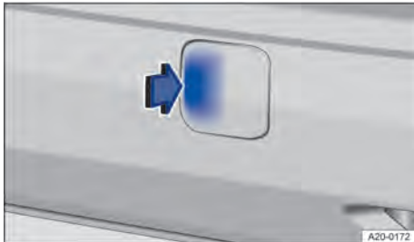
Abb. 195 Im Stoßfänger hinten rechts: Abdeckung abnehmen.
