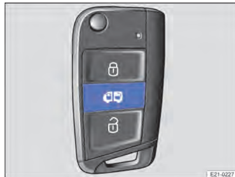
Abb. 60 Am Fahrzeugschlüssel: Taste zum Entriegeln des Laderaums.
