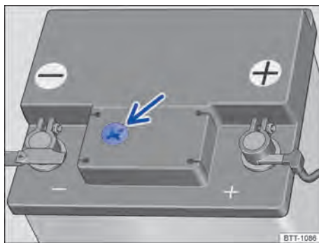
Abb. 210 Sichtfenster an der Oberseite der 12-Volt-Fahrzeugsbatterie (Prinzipdarstellung).
