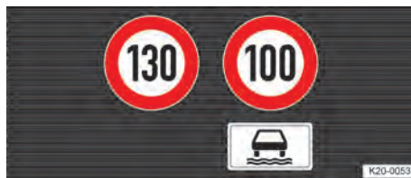
Abb. 18 Im Display des Kombiinstrumentes: Anzeigen der Verkehrsschilderkennung mit erkanntem Zusatzzeichen (Prinzipdarstellung).
