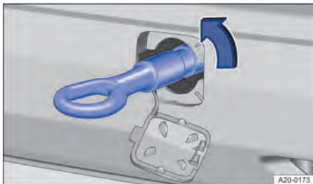
Abb. 196 Im Stoßfänger hinten rechts: Abschleppöse einschrauben.
