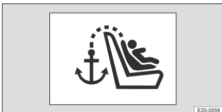
Abb. 45 Prinzipdarstellung: Kennzeichnung für Top Tether-Verankerung.
