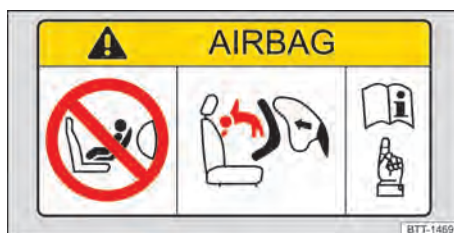
Abb. 40 Prinzipdarstellung: Airbag-Label an der Sonnenblende.
