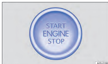
Abb. 103 Im unteren Teil der Mittelkonsole: Startknopf zum Anlassen des Motors.
