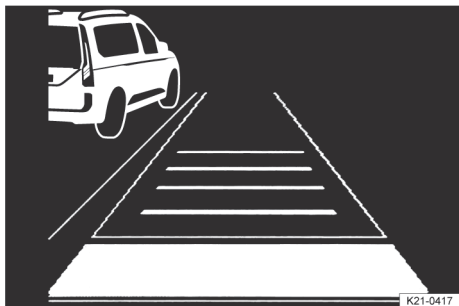
Abb. 120 Im Display des Kombiinstrument: Langsames Fahrzeug auf der linken Spur erkannt (Prinzipdarstellung).
