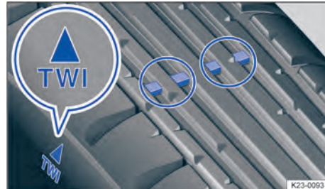
Abb. 226 In den Profilrillen: Verschleißanzeiger.
