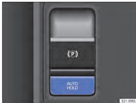
Abb. 130 In der Mittelkonsole: Taste für Auto Hold.
