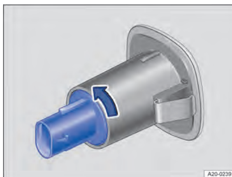
Abb. 192 Glühlampe des Seitenblinklichts ersetzen.
