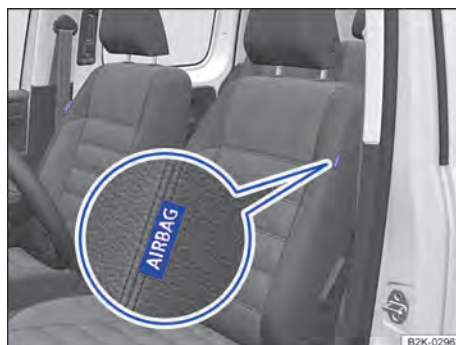
Abb. 34 Seitlich im Vordersitz: Einbauort des Seitenairbags.
