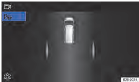
Abb. 136 Infotainment-System: Suchfahrt des Park Assistent (Prinzipdarstellung).
