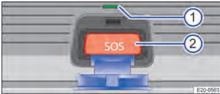
Abb. 52 Bedienelement für Notruf: Kontrollleuchte und Taste.
