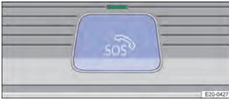
Abb. 51 In der Dachkonsole: Taste für Notrufsystem eCall (hinter Tastenabdeckung) und Kontrollleuchte.
