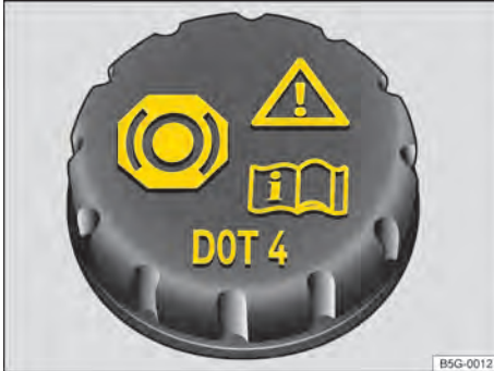
Abb. 221 Im Motorraum: Deckel des Bremsflüssigkeitsbehälters.
