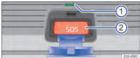
Abb. 54 Bedienelement für Notruf: Kontrollleuchte und Taste für Notrufsystem eCall.
