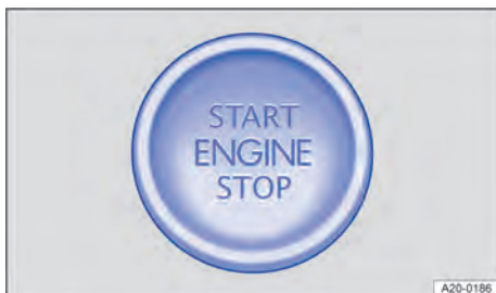
Abb. 108 Im unteren Teil der Mittelkonsole: Starterknopf zum Anlassen des Motors.
