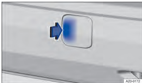
Abb. 208 Im Stoßfänger hinten rechts: Abdeckung abnehmen.
