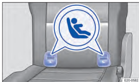
Abb. 43 Am Fahrzeugsitz dritte Sitzreihe: Kennzeichnungsvarianten der ISOFIX-Verankerungspunkte für Kindersitze.
