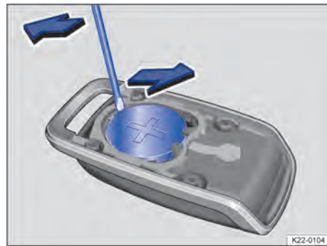
◀ Abb. 104 Funkfernbedienung: Knopfzelle wechseln.
