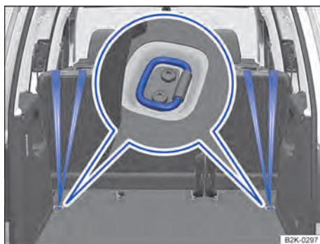
Abb. 46 Äußere Sitzplätze der zweiten Sitzreihe: eingehängte Top Tether-Gurte in seitlich verschraubten Verzurrösen im Laderaum.
