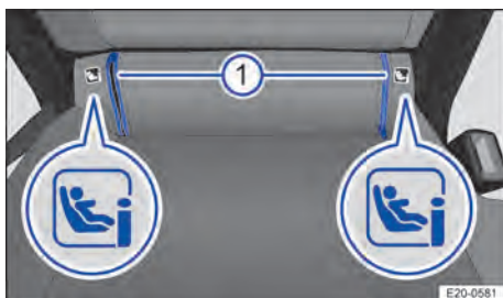
Abb. 42 Am Fahrzeugsitz zweite Sitzreihe: Kennzeichnungsvarianten der i-Size-Verankerungspunkte für Kindersitze.
