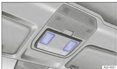
Abb. 94 In der Dachkonsole: Berührungssensitive Leseleuchten.
