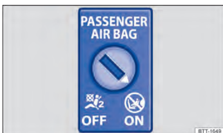
Abb. 30 An der Stirnseite der Instrumententafel: Schüsselschalter zum Aus- und Einschalten des Beifahrer-Frontairbags.
