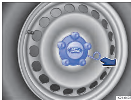
Abb. 230 Radmittenblende abziehen (Prinzipdarstellung).
