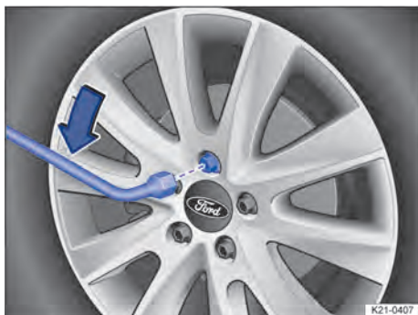
Abb. 238 Radschrauben mit dem Radschlüssel abschrauben.
