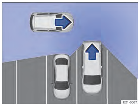
Abb. 143 Überwachter Bereich um das ausparkende Fahrzeug (Prinzipdarstellung).
