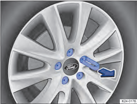
Abb. 232 Abdeckkappen von den Radschrauben mit dem Abziehbügel abziehen (Prinzipdarstellung).
