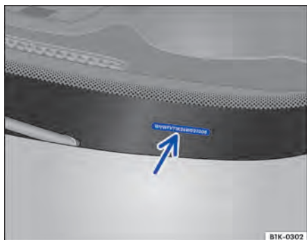
Abb. 283 In der Frontscheibe: Fahrzeug-Identifizierungsnummer.
