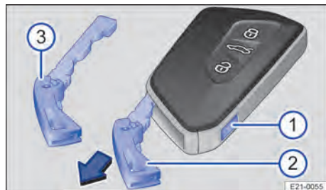
Abb. 55 Fahrzeugschlüssel: Entriegelung des Notschlüssels.
