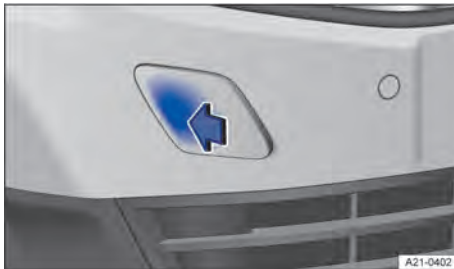
Abb. 206 Im Stoßfänger vorn rechts: Abdeckung abnehmen.
