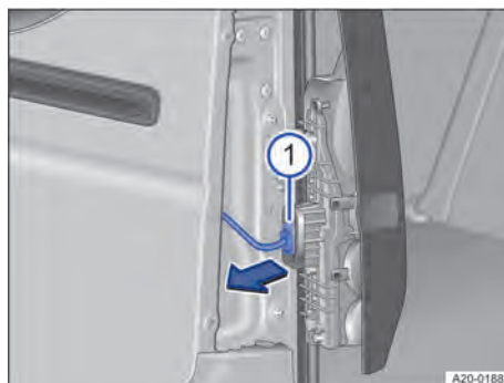
Abb. 194 An der Rückleuchte: Steckverbindung abziehen.
