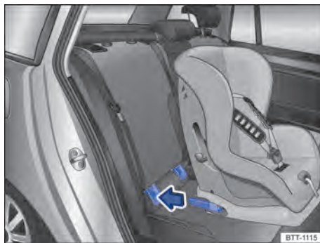
Abb. 44 Kindersitz mit Rastarmen einbauen (Prinzipdarstellung).
