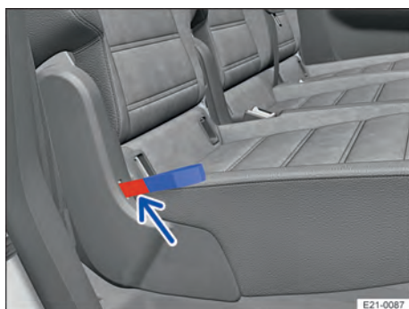
Abb. 72 Zweite Sitzreihe: Markierung für nicht sicher eingerastete Sitzlehne.
