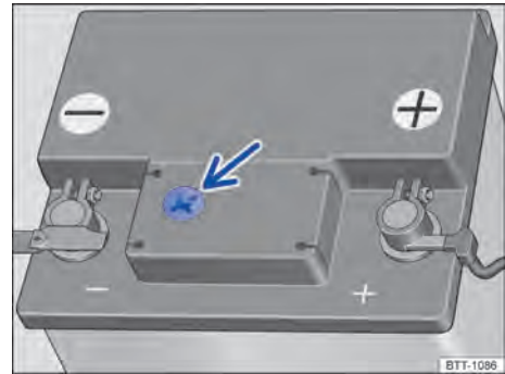
Abb. 222 Sichtfenster an der Oberseite der 12-Volt-Fahrzeugsbatterie (Prinzipdarstellung).
