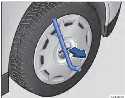
Abb. 231 Radvollblende abziehen (Prinzipdarstellung).
