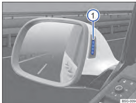
Abb. 127 In den Gehäusen der Außenspiegel: Optische Anzeigen des Spurwechselwarners.
