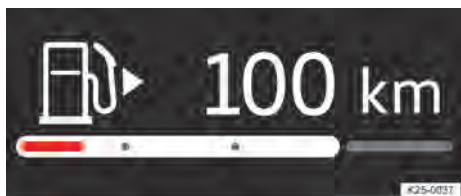
Abb. 14 Im digitalen Kombiinstrument: Kraftstoffvorratsanzeige (Prinzipdarstellung).
