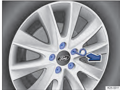
Abb. 233 Abdeckkappen von den Radschrauben mit dem Abziehhaken abziehen (Prinzipdarstellung).
