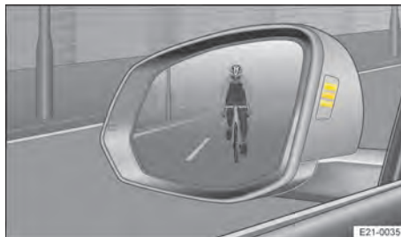
Abb. 129 Im Gehäuse der Außenspiegel: Anzeige der Ausstiegswarnung (Prinzipdarstellung).
