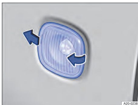
Abb. 191 An der Fahrzeugseite: Seitenblinklicht ausbauen.
