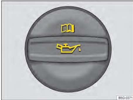
Abb. 216 Im Frontraum: Deckel der Motoröleinfüllöffnung (Prinzipdarstellung).
