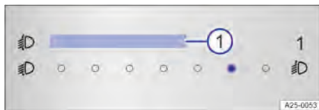
Abb. 93 Im Infotainment-System: Schieberegler für Leuchtweitenregulierung.
