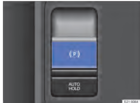
Abb. 128 In der Mittelkonsole: Taste für die Parkbremse (Prinzipdarstellung).
