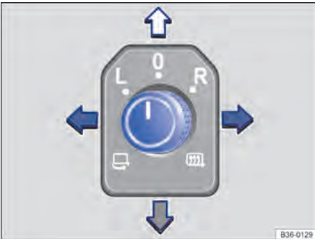
Abb. 100 In der Fahrertür: Drehknopf für die Außenspiegel.
