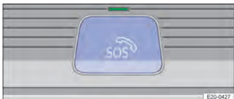
Abb. 53 In der Dachkonsole: Taste für Notrufsystem eCall (hinter Tastenabdeckung).
