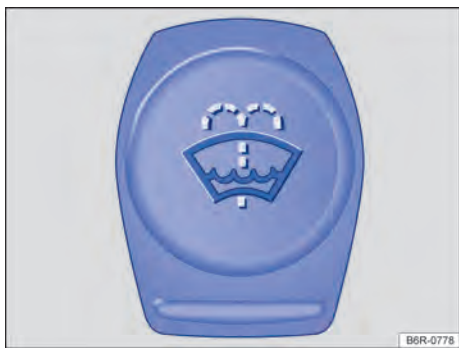
Abb. 215 Im Motorraum: Deckel des Scheibenwaschwasserbehälters (Prinzipdarstellung).
