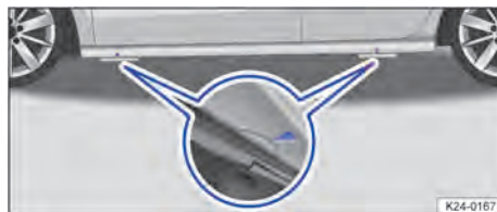
Abb. 235 Am Seitenschweller: Markierungen für die Aufnahmepunkte des Wagenhebers.
