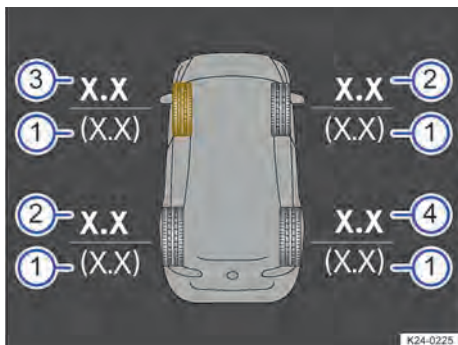
Abb. 227 Displayanzeige im Infotainment-System: Aktuelle Reifendrücke (Prinzipdarstellung).
