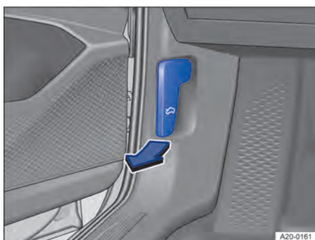
Abb. 210 Im Fußraum links: Entriegelungshebel für die Frontklappe (Prinzipdarstellung).
