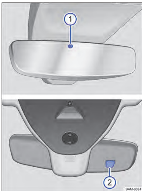
Abb. 98 An der Frontscheibe: Automatisch abblendender Innenspiegel.
