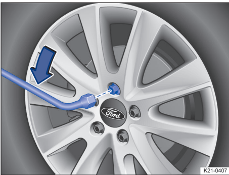
Fig. 218 Înlocuirea roții: deșurubați șuruburile de roată cu cheia de roată.
