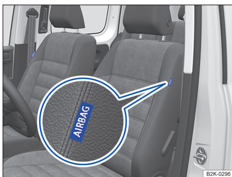
Fig. 34 Lateral, în scaunul din față: Locul de amplasare al airbagului lateral.
