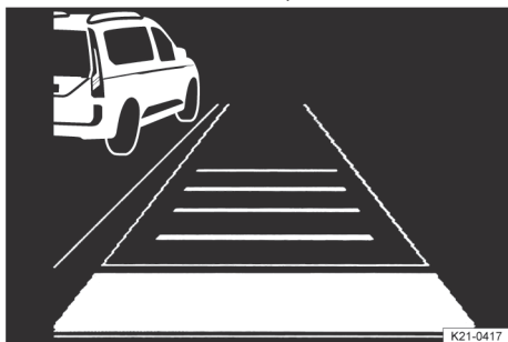
Fig. 109 Pe afișajul din panoul de bord: s-a detectat un autovehicul mai lent pe banda din stânga (imagine de referință).
