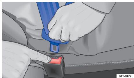
Fig. 24 Desfacerea limbii centurii din catarama centurii de siguranță.
