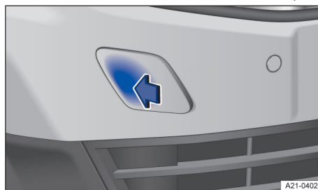
Fig. 189 În bara de protecție dreapta-față: demontarea capacului.
