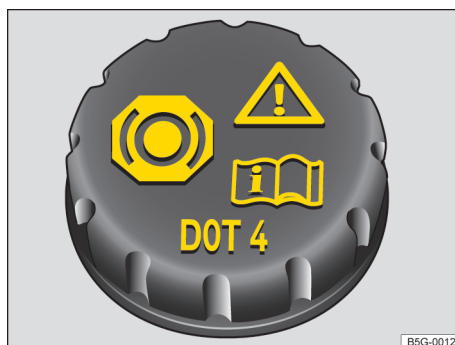
Fig. 201 În compartimentul motorului: capacul rezorului lichidului de frână.
