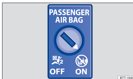
Fig. 32 În partea frontală a planșei de bord: Înterupător cu cheie pentru dezactivarea și activarea airbagului frontal al pasagerului din față.
