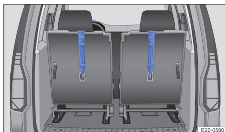
Fig. 47 Al treilea rând de scaune: chingi de fixare superioare agățate (în funcție de echipare).
