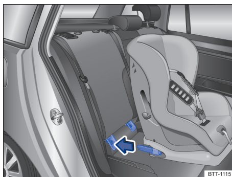
Fig. 43 Imagine de referință: Montarea scaunului pentru copii ISOFIX cu brațe de fixare.
