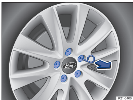
Fig. 212 Scoateți capacele de pe șuruburile de roți.
