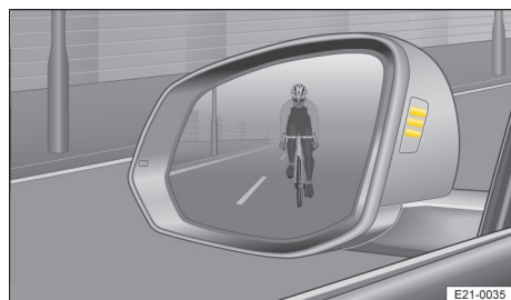
Fig. 124 În carcasa oglinzii exterioare: indicatorul optic de avertizare la părăsirea autovehiculului.
