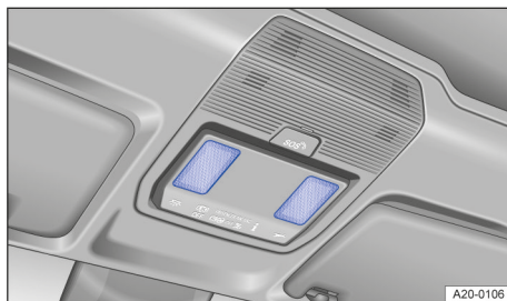
Fig. 85 În consola din plafon: lămpi de lectură sensibile la atingere.
