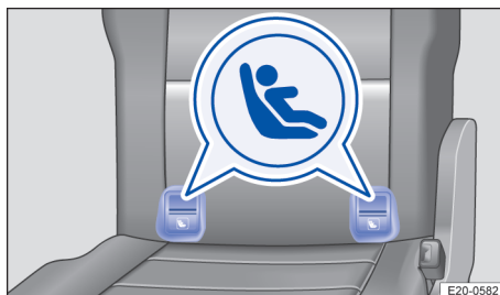
Fig. 42 La scaunul autovehiculului din rândul al treilea: variante de marcare a punctelor de ancorare ISOFIX pentru scaunele pentru copii.
