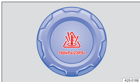
Fig. 199 În compartimentul motor: Capacul vasului de expansiune al lichidului de răcire.
