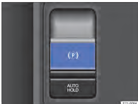
Obr. 125 Ve středové konzole: tlačítko parkovací brzdy.
