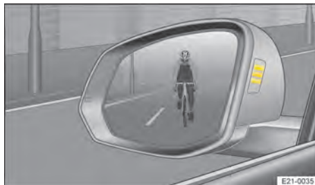
Obr. 126 V krytu vnějšího zpětného zrcátka: zobrazení asistenta varování při vystupování z vozu (schematické zobrazení).
