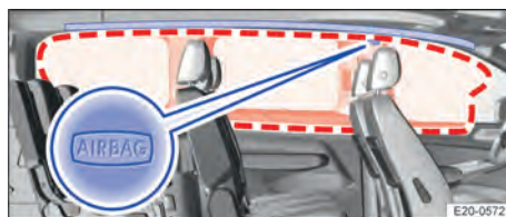
Obr. 37 Na levé straně vozidla: montážní poloha a oblast rozpínání hlavových airbagů (7místné).
