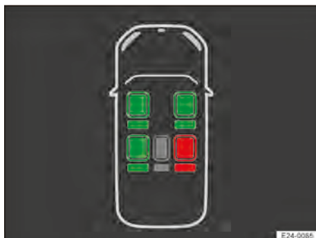
Obr. 22 Na displeji sdužených přístrojů: výzva k zapnutí bezpečnostních pásů (schématické zobrazení).
