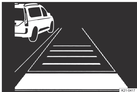
Obr. 117 Na displeji sdružených přístrojů: rozpoznáno pomaleji jedoucí vozidlo v levém pruhu (schematické znázornění).
