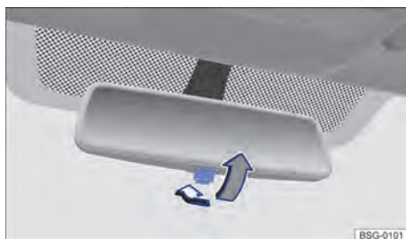
Obr. 96 Na čelním skle: manuálně zastínitelné vnitřní zrcátko.
