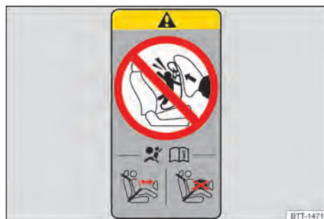
Obr. 41 Schematické znázornění: štítek airbag na sloupku B.
