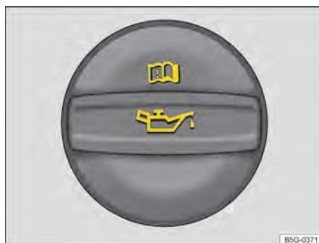
Obr. 209 Motorový prostor: uzávěr plnicího otvoru motorového oleje (schematické znázornění).
