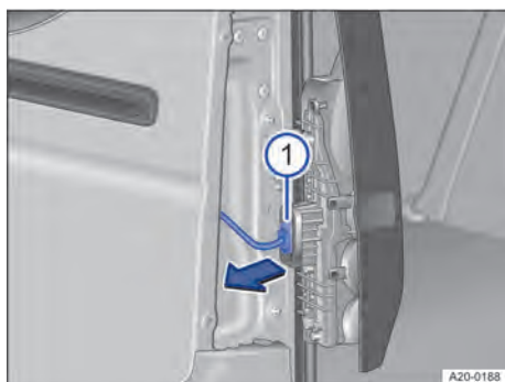
Obr. 186 Na zadním světle: odpojení konektorového spojení.
