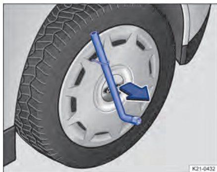
Obr. 222 Sejmutí celoplošného krytu kola (schematické zobrazení).
