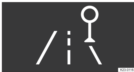
Obr. 17 Na displeji sdružených přístrojů: symbol asistenta dopravního značení.
