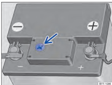
Obr. 213 Kontrolní okénko na horní straně akumulátoru vozidla 12 Volt (schematické zobrazení).
