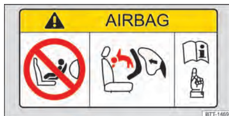
Obr. 40 Schematické znázornění: štítek airbag na sluneční cloně.
