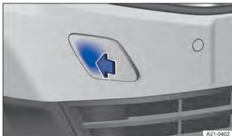
Obr. 198 V předním nárazníku vpravo: sejmутí krytu.
