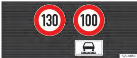
Obr. 18 Na displeji sdružených přístrojů: zobrazení rozpoznávání dopravních značek s rozpoznanými dodatkovými tabulkami (schematické zobrazení).
