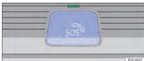
Obr. 51 Ve střešní konzole: ovládací prvek systému nouzového volání eCall (za krytem tlačítek).
