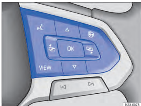
Obr. 11 Pravá strana multifunkčního volantu: ovládání digitálních sdružených přístrojů Pro (schematické zobrazení).
