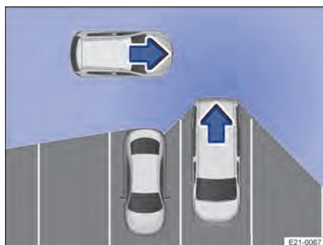
Obr. 137 Schematické zobrazení upozornění při couvání: kontrolovaná oblast kolem vyjíždějícího vozidla.
