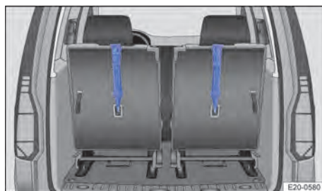
Obr. 48 Třetí řada: zavěšené popruhy Top Tether v ukotvení Top Tether (v závislosti na výbavě).
