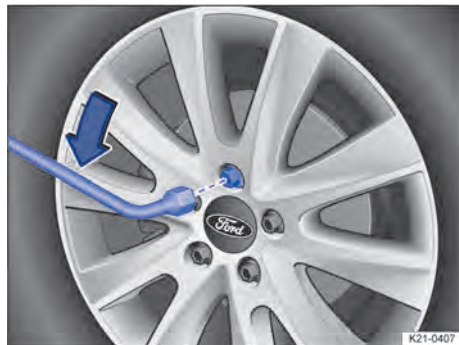
Obr. 228 Odšroubování šroubů kol klíčem na kola.
