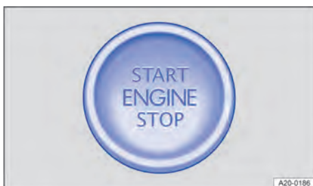
Obr. 105 Ve spodní části středové konzoly: tlačítko zapalování ke spuštění motoru.
