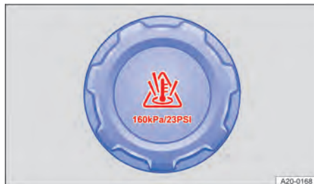
Obr. 210 V čelním prostoru: víko nádržky chladicí kapaliny.
