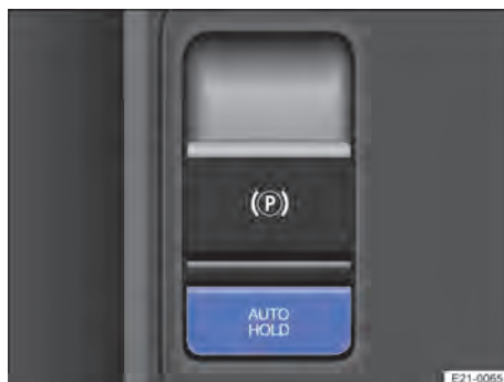
Obr. 127 Ve středové konzole: tlačítko funkce Auto Hold.
