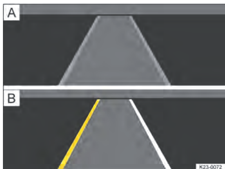
Obr. 121 Na displeji sručených přístrojů: zobrazení na displeji pro systém udržování pruhu (schematické zobrazení).
