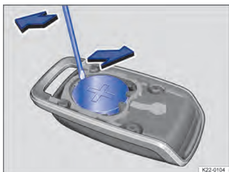
Obr. 101 Rádiové dálkové ovládání: výměna knoflíkové baterie.
