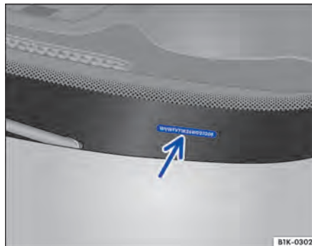
Obr. 265 V čelním skle: identifikační číslo vozidla.
