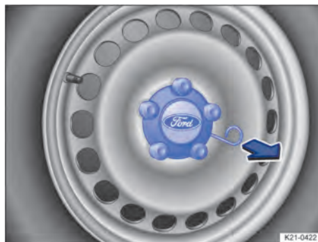
Obr. 221 Sejmutí krytu středu kola (schematické zobrazení)
