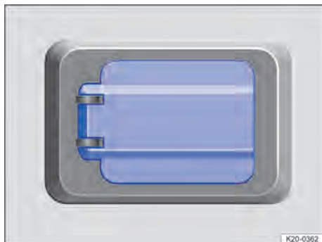
Obr. 143 Na středové konzole vzadu nebo na dělicí stěně k ložnému prostoru: výklopná zásuvka 230 Volt s ochranným kontaktem (schematické zobrazení).
