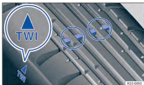
Obr. 217 V drážkách profilu: ukazatel opotřebení.
