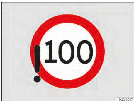
Obr. 19 Na displeji sručených přístrojů: Rozpoznané překročení přípustné maximální rychlosti (schematické zobrazení).
