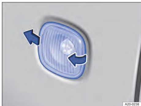
Obr. 183 Na straně vozidla: demontáž boční směrovky.
