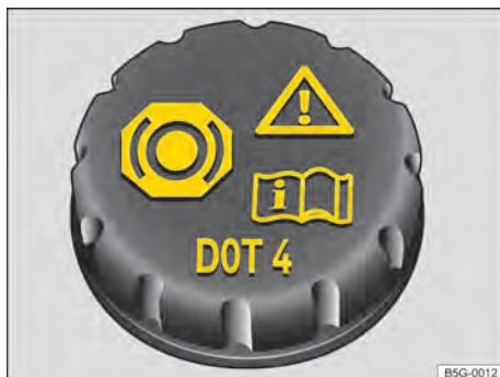
Obr. 212 V motorovém prostoru: uzávěr nádrží brzdové kapaliny.
