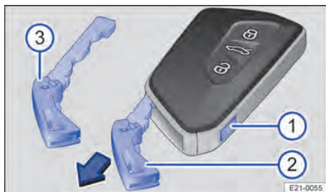
Obr. 53 Klíček od vozidla: odjištění nouzového klíčku.
