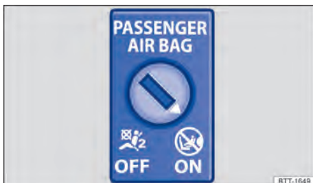
Obr. 30 Na čelní straně přístrojové desky: zámkový vypínač k vypnutí a zapnutí čelního airbagu na straně spolujezdce
