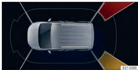
Obr. 138 Na obrazovce systému Infotainment: zobrazení upozornění při couvání.
