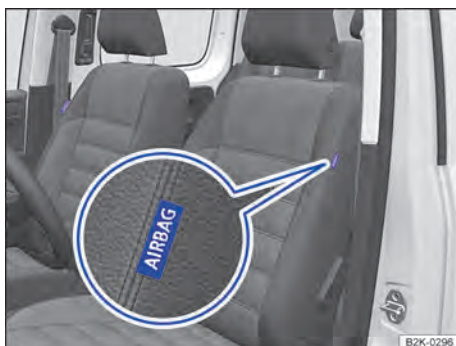
Obr. 34 Přední sedadlo ze strany: montážní poloha bočního airbagu
