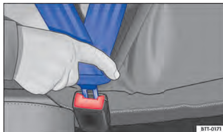
Obr. 23 Zasunutí západky zámku bezpečnostního pásu do zámku pásu
