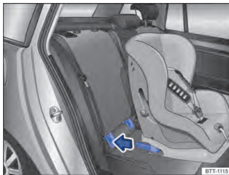
Obr. 44 Schematické znázornění: montáž dětské sedačky ISOFIX s aretovacími rameny.
