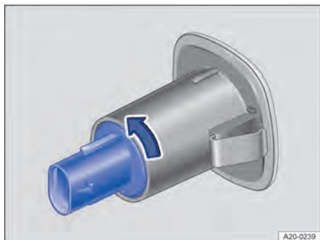
Obr. 184 Výměna žárovky boční směrovky.
