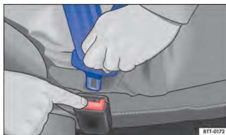
Obr. 24 Uvolnění západky ze zámku pásu
