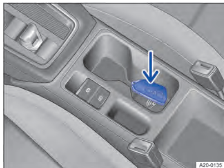
Obr. 106 Ve středové konzole: funkce nouzového startu.
