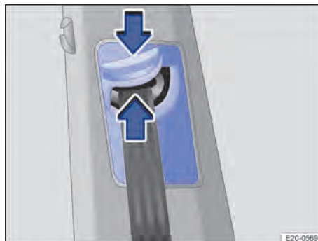
Obr. 27 Vedle předních sedadel: nastavení výšky pásu
