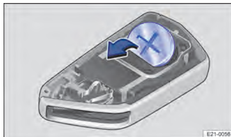
Obr. 56 Klíček od vozidla: výměna knoflíkové baterie.
