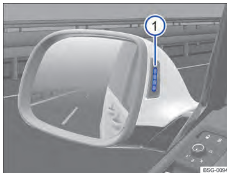
Obr. 124 V tělese vnějších zrcátek: optické ukazatele asistenta mrtvého úhlu.
