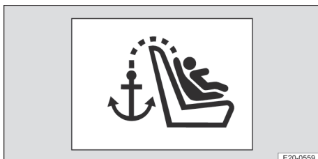
Obr. 45 Schematické zobrazení: označení ukotvení Top Tether.
