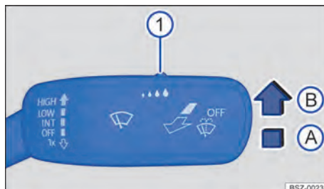
Obr. 94 Na sloupku řízení vpravo: páčka stěračů.
