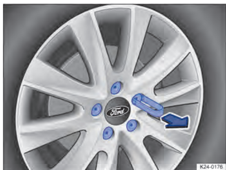
Obr. 223 Stáhnutí krytek ze šroubů kola (schematické zobrazení)
