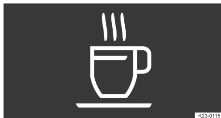
Obř. 16 Na displeji sdružených přístrojů: symbol varování pozornosti.
