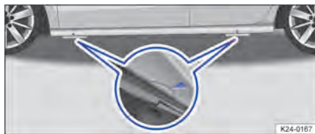
Obr. 225 Na bočním prahu: značky pro upevňovací body zvedáku.
