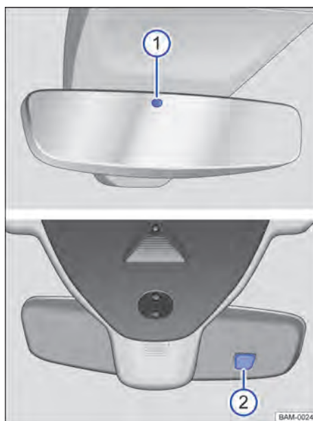
Obr. 95 Na čelním skle: automaticky zastínitelné vnitřní zrcátko.
