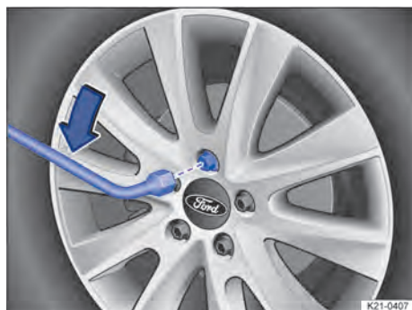
Obr. 224 Povolení šroubů kol.
