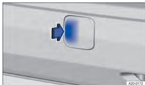
Obr. 200 V zadním nárazníku vpravo: sejmutí krytu.
