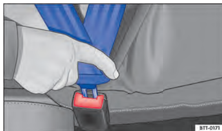
Fig. 23 Insertion du pêne de la ceinture de sécurité dans le boîtier de verrouillage
