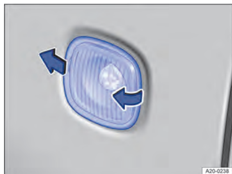
Fig. 177 Sur le côté du véhicule : dépose de l'ampoule de clignotant latéral
