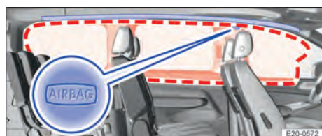
Fig. 36 Sur le côté gauche du véhicule : emplacement de montage et zone de déploiement du sac gonflable de tête (7 places)
