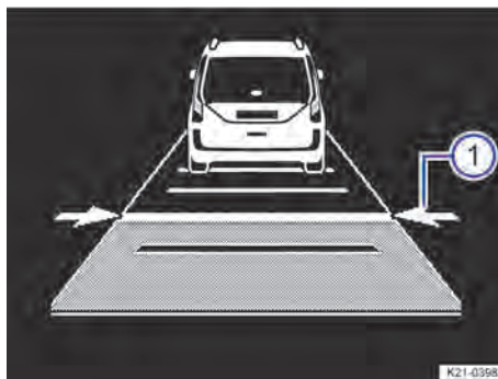
Fig. 116 Sur l'afficheur du combiné des instruments analogique : distance réglée ①, le régulateur de vitesse adaptatif est en phase de régulation (schéma de principe)
