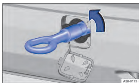
Fig. 189 Dans le pare-chocs arrière, côté droit : vissage de l'œillet de remorquage
