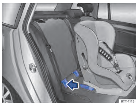
Fig. 43 Schéma de principe : installation d'un siège pour enfants ISOFIX avec verrous
