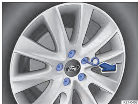
Fig. 213 Retrait des capuchons de boulons de roue
