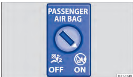
Fig. 30 Sur la face avant du tableau de bord : commande à clé de désactivation et d'activation du sac gonflable du passager avant
