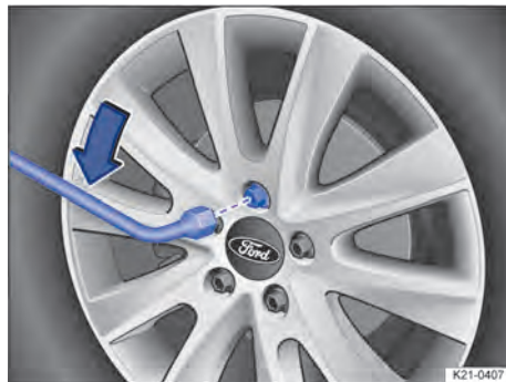
Fig. 214 Changement de roue : desserrage des boulons de roue
