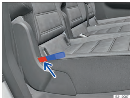
Fig. 66 Deuxième rangée de sièges : Repère indiquant que le dossier de siège n'est pas correctement encliqueté.
