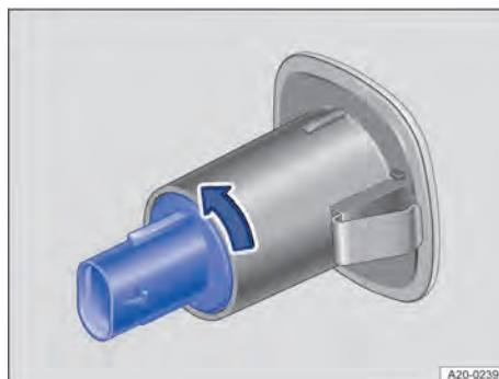
Fig. 178 Remplacement de l'ampoule de clignotant latéral
