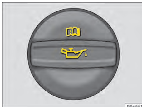
Fig. 199 Dans le compartiment-moteur : bouchon de l'orifice de remplissage d'huile-moteur (schéma de principe)
