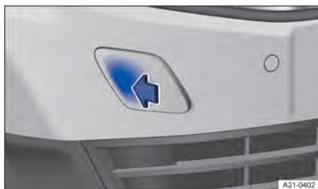
Fig. 190 Dans le pare-chocs avant, du côté droit : dépose du cache
