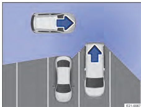
Fig. 139 Schéma de principe de l'alerte circulation transversale : zone surveillée autour du véhicule sortant de la place de stationnement
