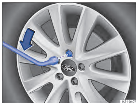
Fig. 219 Changement d'une roue : dévissage des boulons de roue avec la clé de roue
