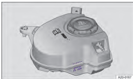
Fig. 201 Dans le compartiment-moteur : repère sur le vase d'expansion de liquide de refroidissement (schéma de principe)
