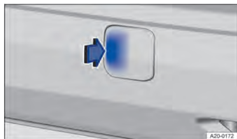
Fig. 188 Dans le pare-chocs arrière, côté droit : retrait du cache
