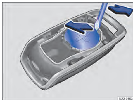
Fig. 96 Radiocommande : remplacement de la pile bouton
