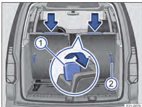
Fig. 72 Troisième rangée de sièges : basculement des dossiers vers l'avant
