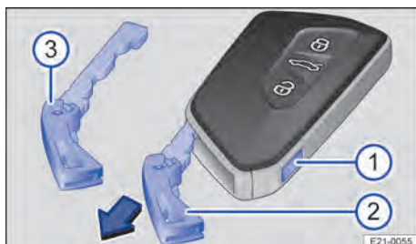
Fig. 51 Clé du véhicule : déverrouillage de la clé de secours
