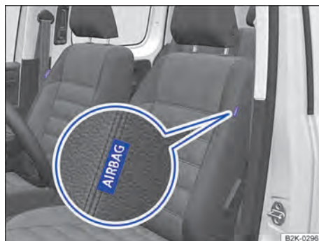
Fig. 34 Latéralement dans le siège avant : emplacement de montage du sac gonflable latéral
