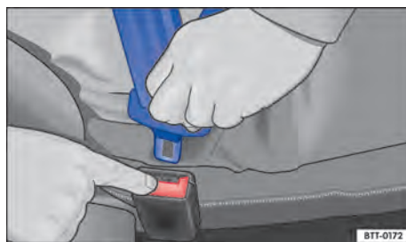
Fig. 24 Retrait du pêne du boîtier de verrouillage
