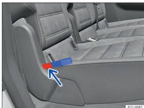
Fig. 70 Deuxième rangée de sièges : repère indiquant que le dossier de siège n'est pas correctement encliqueté
