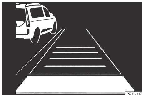
Fig.117 Sur l'afficheur du combiné des instruments : véhicule lent détecté sur la voie de gauche (schéma de principe)
