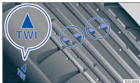
Fig. 217 Dans les rainures : indicateurs d'usure
