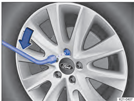
Fig. 228 Dévissage des boulons de roue avec la clé de roue
