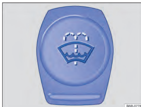
Fig. 207 Dans le compartiment-moteur : bouchon du réservoir de lave-glace
