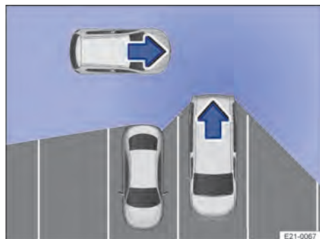
Fig. 137 Schéma de principe de l'alerte circulation transversale : zone surveillée autour du véhicule sortant de la place de stationnement
