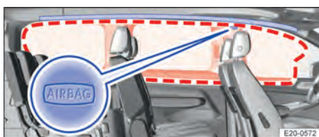
Fig. 37 Sur le côté gauche du véhicule : emplacement de montage et zone de déploiement du sac gonflable de tête (7 places)
