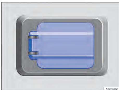
Fig. 143 Sur la console centrale arrière ou sur la paroi de séparation avec le compartiment de charge : prise de courant de sécurité 230 volts rabattable (schéma de principe)
