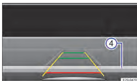
Fig. 131 Système d'infodivertissement : alignement du véhicule dans la place de stationnement
