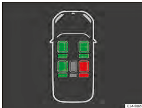
Fig. 22 Sur l'afficheur du combiné d'instruments : rappel de bouclage des ceintures (schéma de principe)
