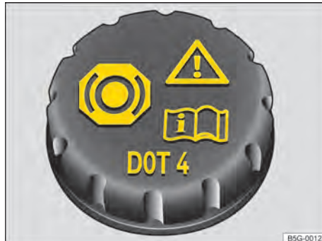
Fig. 212 Dans le compartiment-moteur : bouchon du réservoir de liquide de frein
