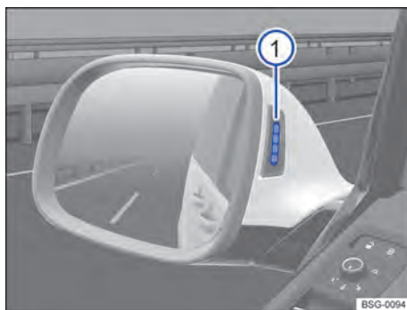
Fig. 124 Dans le boîtier du rétroviseur extérieur : voyant de l'assistance angles morts
