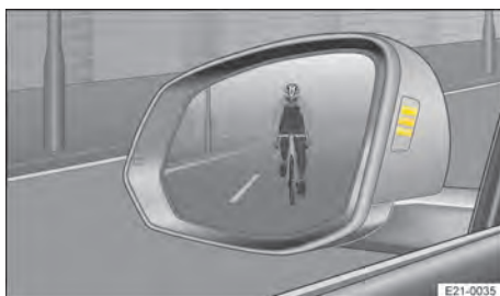
Fig. 126 Dans le boîtier du rétroviseur extérieur : affichage de l'avertissement d'ouverture de porte (schéma de principe)
