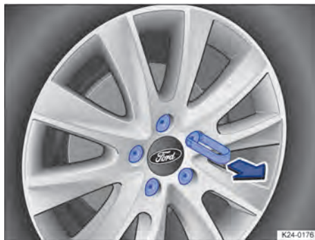
Fig. 223 Dépose des capuchons de boulons de roue (schéma de principe)
