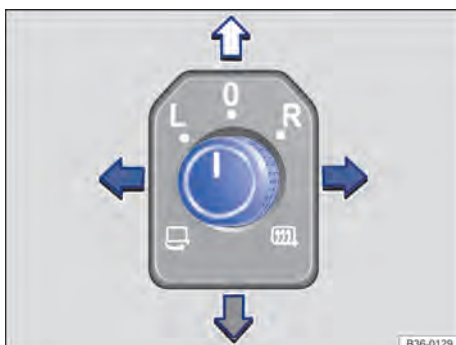
Fig. 97 Dans la porte du conducteur : commande rotative pour les rétroviseurs extérieurs
