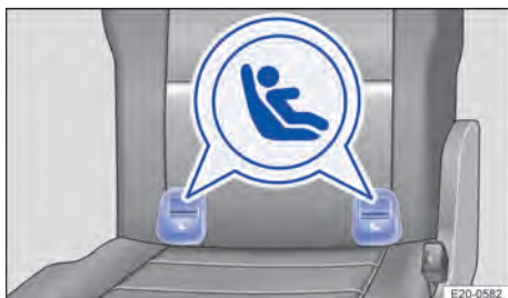
Fig. 43 Sur la troisième rangée de sièges : variantes d'identification des points d'ancrage ISOFIX des sièges pour enfants
