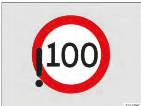
Fig. 19 Sur l'afficheur du combiné des instruments : dépassement de la vitesse maximale autorisée détecté (schéma de principe)
