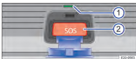
Fig. 52 Élément de commande pour l'appel d'urgence : témoin de contrôle et touche
