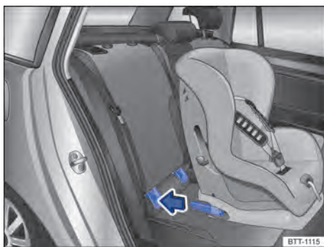
Fig. 44 Schéma de principe : installation d'un siège pour enfants ISOFIX avec verrous
