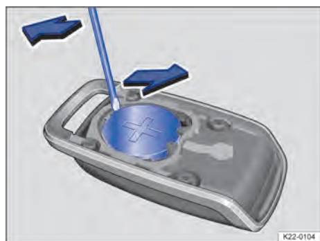
Fig. 101 Radiocommande : remplacement de la pile bouton
