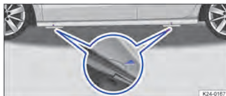
Fig. 225 Au niveau du bas de caisse latéral : repères pour les points de prise du cric
