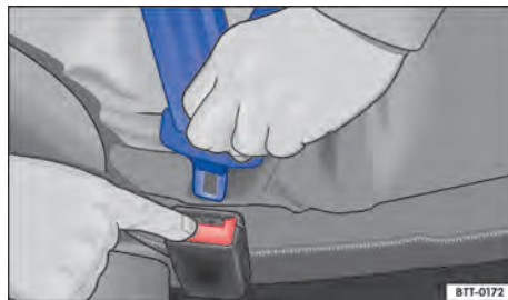
Fig. 24 Retrait du pêne du boîtier de verrouillage
