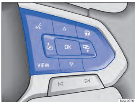
Fig. 13 Côté droit du volant multifonction : utilisation du combiné des instruments numérique (schéma de principe)
