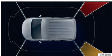
Fig. 138 Sur l'écran du système d'infodivertissement : affichage de l'alerte circulation transversale
