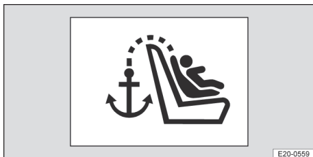
Fig. 45 Schéma de principe : repérage du point d'ancrage pour Top Tether
