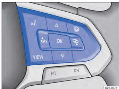
Fig. 11 Côté droit du volant multifonction : utilisation du combiné des instruments numérique Pro (schéma de principe)
