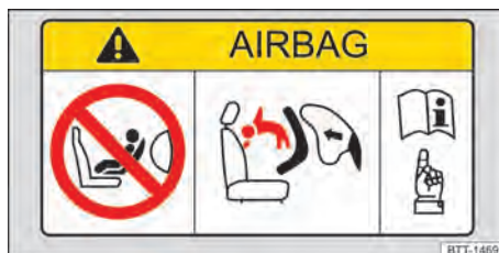
Fig. 40 Schéma de principe : autocollant de sac gonflable sur le pare-soleil
