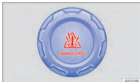
Fig. 210 Dans le compartiment avant : bouchon du vase d'expansion du liquide de refroidissement
