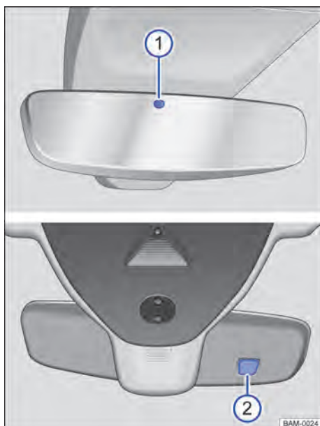
Fig. 95 Sur le pare-brise : rétroviseur intérieur photosensible
