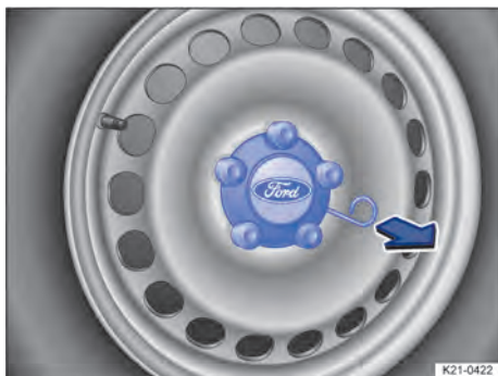
Fig. 221 Retrait de l'enjoliveur central (schéma de principe)
