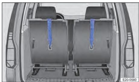
Fig. 48 Montage sur la troisième rangée de sièges : ceintures Top Tether accrochées à l'ancrage Top Tether (en fonction de l'équipement)
