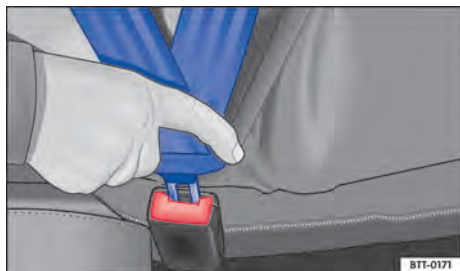
Fig. 23 Insertion du pêne de la ceinture de sécurité dans le boîtier de verrouillage
