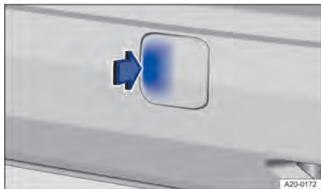
Fig. 200 Dans le pare-chocs arrière droit : retrait du cache
