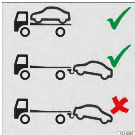
Fig. 197 Transport par dépanneuse
