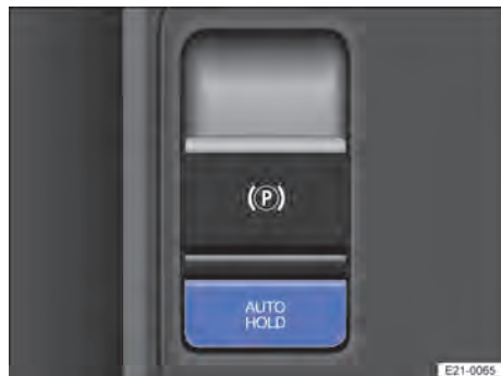
Fig. 127 Dans la console centrale : touche pour Maintien auto
