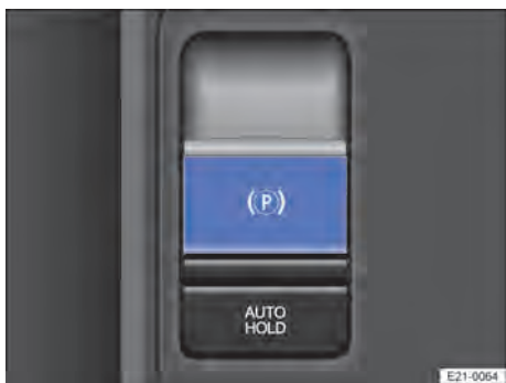
Fig. 125 Dans la console centrale : touche du frein de parking
