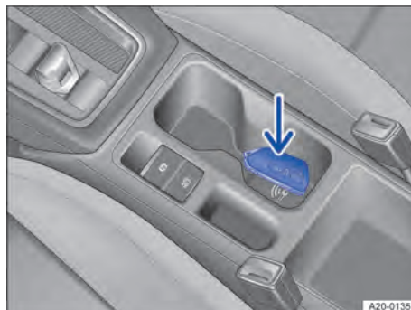
Fig. 106 Dans la console centrale : fonction de démarrage de secours
