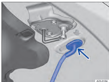
Fig. 205 Sur le capot avant : logement de la béquille de capot
