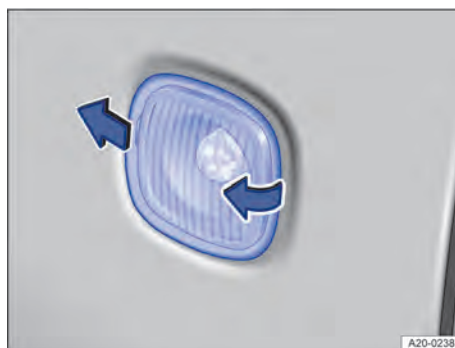
Fig. 183 Sur le côté du véhicule : dépose de l'ampoule de clignotant latéral
