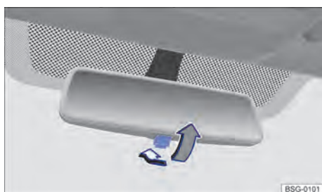
Fig. 96 Sur le pare-brise : rétroviseur intérieur jour/nuit manuel
