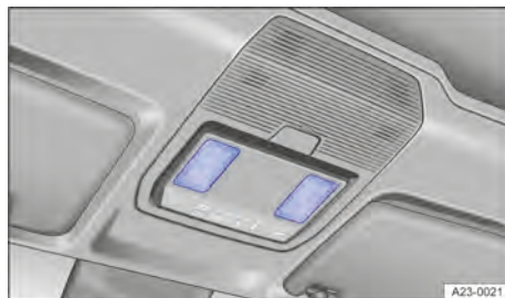
Fig. 91 Dans la console de pavillon : lampes de lecture tactiles
