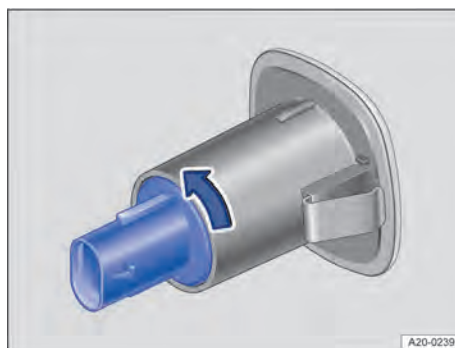
Fig. 184 Remplacement de l'ampoule de clignotant latéral
