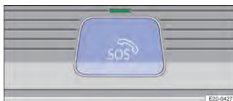
Fig. 51 Dans la console de pavillon : éléments de commande pour le système d'appel d'urgence eCall (derrière le couvre-touche)
