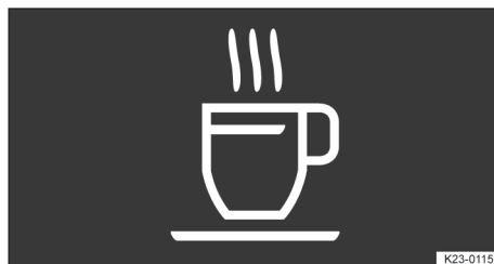
Fig. 16 Sur l'afficheur du combiné des instruments : symbole d'alerte de vigilance
