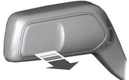
Den Hebel in Richtung Körper ziehen und wieder freigegeben, um die Lichttupe zu betätigen.
