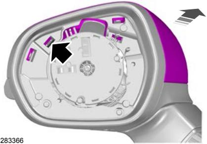
4. Die Gehäuseabdeckung vorsichtig mit einem geeigneten Werkzeug, z. B. einem Schraubendreher, durch die Zugangsöffnung herausdrücken.
