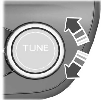
Zum Ändern der Frequenz den Regler drehen.
