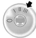
3. Den Schlüssel in Stellung III drehen und warten, bis der Motor durchdreht.
