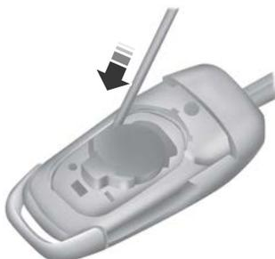
5. Führen Sie einen Schraubendreher an der gezeigten Stelle ein, um die Batterie zu lösen.
