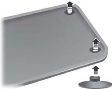
Zum Einlegen der Bodenmatten, diese mit der Öse auf den Befestigungspunkt legen und bis zum Einrasten nach unten drücken.
