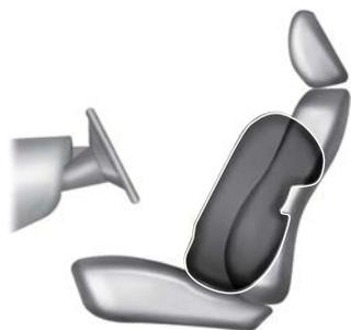
Los airbags laterales están diseñados para inflarse entre el panel de puerta y el ocupante, para aumentar la protección en determinados casos de accidente.
