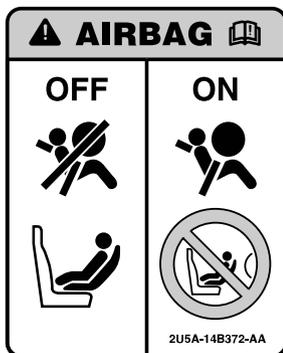
El interruptor se encuentra en el lado del acompañante, en el extremo del cuadro de instrumentos del vehículo. El testigo de desactivación del airbag del acompañante está junto a los controles de climatización.
