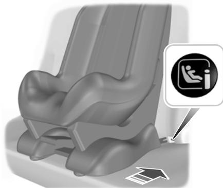
El sistema ISOFIX dispone de dos brazos de enganche rígidos en el sistema de seguridad para niños. Los brazos se fijan a los puntos de anclaje de los asientos de la segunda fila, donde se unen la banqueta y el respaldo.
