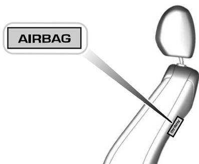
Los airbags laterales se encuentran en el lado más exterior del respaldo del asiento delantero. Hay una etiqueta fijada en el lateral de cada respaldo que lo indica.
