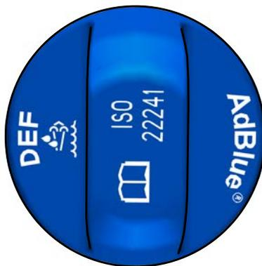
El tubo de llenado del depósito de AdBlue® se encuentra junto al tubo de llenado del depósito de combustible y tiene un tapón azul. Llene el depósito con una bomba de líquido en una estación de servicio de AdBlue® o con un recipiente de AdBlue®.
