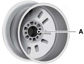
1. Inspeccione el orificio de la rueda piloto (**A**) y la superficie de montaje antes de la instalación. Elimine cualquier corrosión o partícula suelta.
