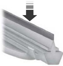
Deslice la punta de sus dedos sobre el filo de la escobilla para comprobar si está rugosa.
