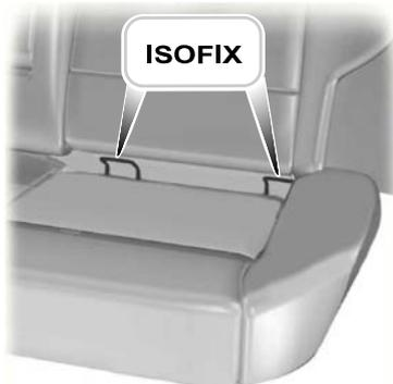
2. Presione sobre el respaldo del dispositivo de sujeción para niños firmemente para enganchar los puntos de anclaje ISOFIX inferiores.
