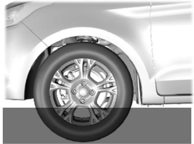
Al conducir por charcos, circule muy lentamente y no detenga el vehículo. El rendimiento del frenado o de la tracción puede estar limitado. Tras haber conducido por agua y tan pronto como sea seguro hacerlo deberá:
