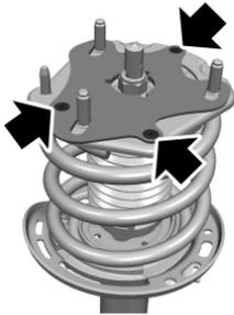
**Nota:** los montajes superiores de la varilla de apoyo ajustables vienen con tres tornillos de fijación que deben quitarse antes de que se pueda ajustar la comba. Si no puede ajustar la comba, consulte al concesionario autorizado o llame al 800-367-3788 para obtener más detalles sobre cómo quitarlos.
