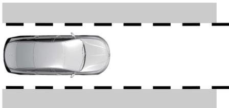
**Solo alerta:** Genera una vibración en el volante de dirección cuando el sistema detecta una desviación no intencional del carril.
