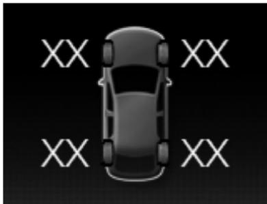
El sistema de control de presión de los neumáticos mide la presión de los neumáticos y envía las lecturas de la presión de los neumáticos al vehículo. Puede visualizar las lecturas de presión de los neumáticos a través de la pantalla de información. La luz de advertencia de baja presión de los neumáticos se enciende cuando la presión de estos está considerablemente baja. Si la luz de advertencia se enciende, los neumáticos
