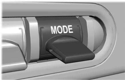
Para cambiar la configuración del modo de manejo, presione el botón de modo en el cuadro de instrumentos ubicado debajo de la pantalla. La primera vez que lo presione, se iluminará el modo seleccionado. Las instancias posteriores cambiarán el modo seleccionado.
