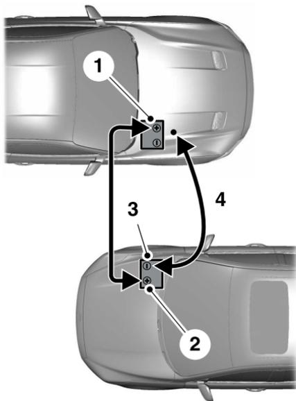
1. Tire de la bota de goma roja hacia atrás. Conecte el cable pasacorriente positivo (+) al terminal positivo (+) de la batería sin carga.
