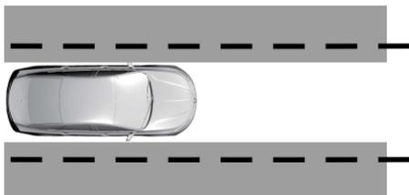
**Solo Asistencia:** Provee asistencia en la dirección hacia el centro del carril cuando el sistema detecta una desviación no intencional del carril.
