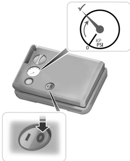
9. Cuando se alcance la presión recomendada en el neumático, desactive el kit, desenchufe el cable y desconecte la manguera de la válvula del neumático. Vuelva a instalar la tapa de la válvula del neumático y coloque el kit nuevamente en el área de almacenamiento.
