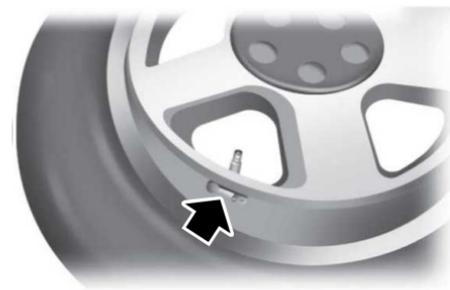
**Nota:** Cada neumático cuenta con un sensor de presión de neumáticos ubicado en la cara interior de la llanta. El sensor de presión está unido al vástago de la válvula. Este sensor está cubierto por el neumático, por lo que no está a la vista a menos que retire el neumático. Tome debida precaución al cambiar los neumáticos para evitar dañar el sensor.
