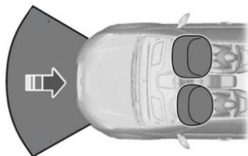
El airbag del acompañante se abrirá en caso de que se produzca un choque grave, ya sea frontal o casi frontal. El airbag se inflará dentro de unas milésimas de segundo y se desinflará al contacto con el ocupante, lo cual amortiguará el movimiento del cuerpo hacia adelante. Durante choques frontales menores, vuelcos, choques traseros y choques laterales, el airbag del acompañante no se desplegará.
