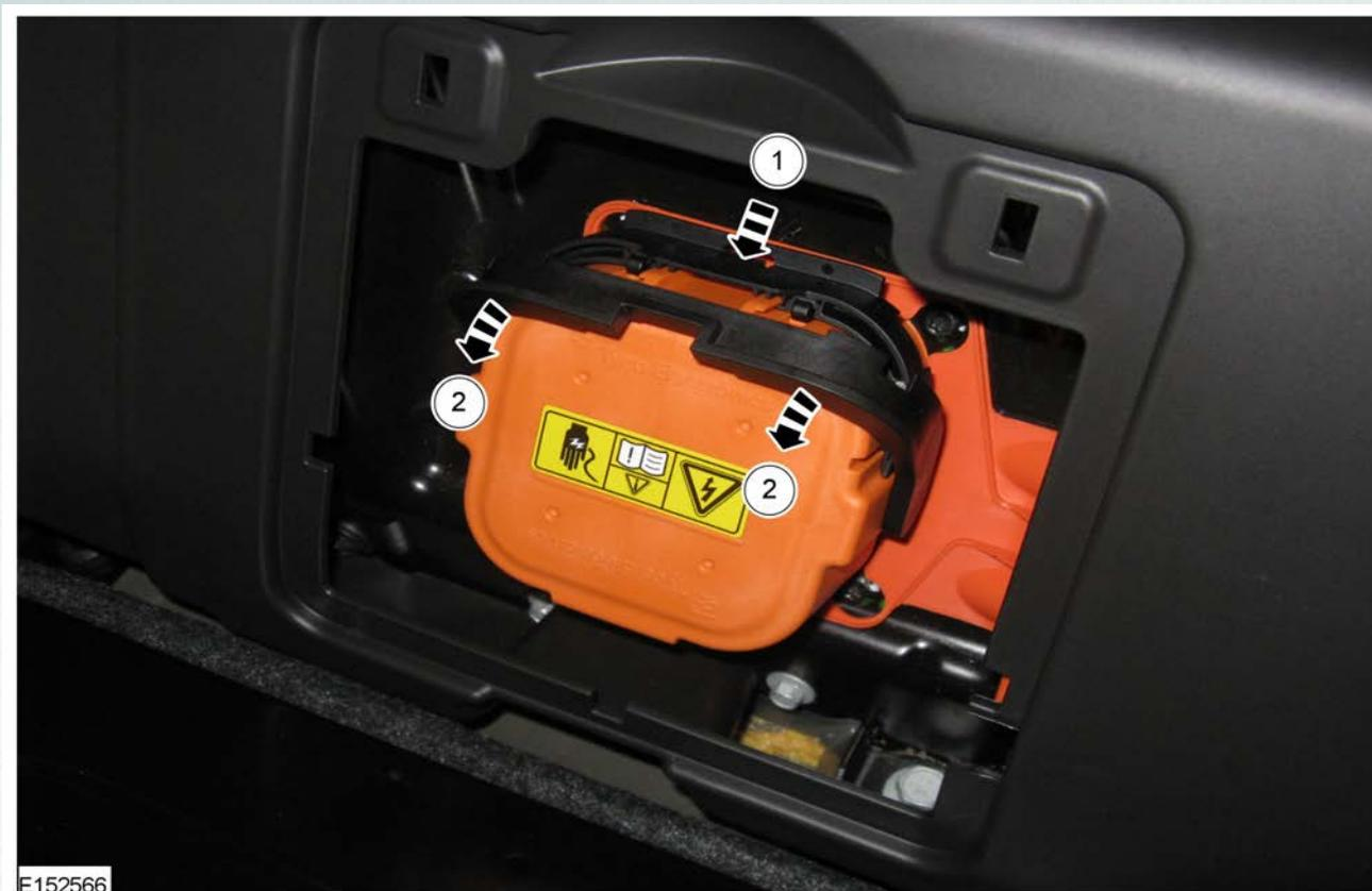
4. Den Freigabeknopf erneut drücken und den Griff um weitere 45 Grad in die vollständig geöffnete Position drehen. Am Griff ziehen, um den oberen Servicestecker abzunehmen.
