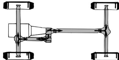
En algunos modelos 4WD, el cambio inicial de tracción de dos ruedas a 4WD mientras el vehículo está en movimiento, puede causar un sonido metálico o de trinquete momentáneo. Estos sonidos son normales y se deben al mecanismo de transmisión delantero que aumenta la velocidad y no son motivo de preocupación.
