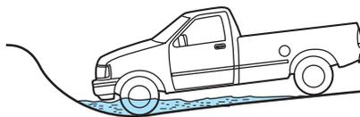
Tras pasar por agua, pruebe siempre los frenos. Los frenos mojados no detienen el vehículo con la eficacia de los frenos secos. Puede secar los frenos más rápido manejando el vehículo lentamente mientras ejerce una leve presión sobre el pedal del freno.
