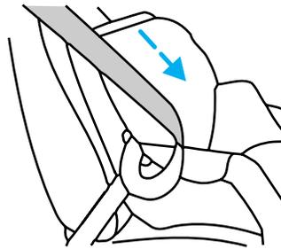
6. Laissez la sangle se rétracter. Un déclic se fait entendre pendant que la ceinture se rétracte et indique que l'enrouleur est passé en mode de blocage automatique.
