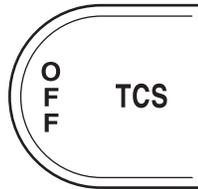
Si votre véhicule est enlisé dans la neige ou la glace, ou sur une chaussée très glissante, il est préférable de désactiver le dispositif antipatinage. Ceci peut vous permettre de faire patiner les roues pour dégager le véhicule par un mouvement de va-et-vient.
