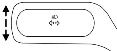
La vitesse de clignotement sera nettement plus rapide si le module d'éclairage détecte qu'une ampoule de clignotant est grillée.
