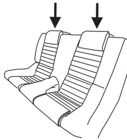
**NOTA :** Les fixations du couvre-capote à l'arrière des appuis-tête ne sont pas des points d'ancrage.
