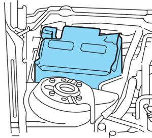
**Si votre batterie est munie d'un couvercle protecteur, assurez-vous de le remettre en place après avoir nettoyé ou remplacé la batterie.**
