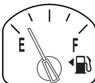
Le pictogramme de pompe à carburant et la flèche indiquent de quel côté du véhicule est située la trappe de carburant.
