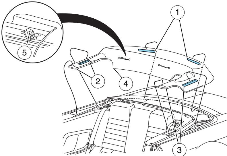
1. Installez le couvre-capote sur le véhicule en agrafant les pinces de retenue de la capote sur le panneau arrière.
