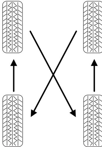
Il peut être possible de corriger une usure irrégulière des pneus en faisant la permutation des pneus.
