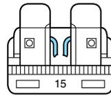
présence d'un fil métallique rompu. Vérifiez les fusibles appropriés avant de remplacer des composants électriques.
