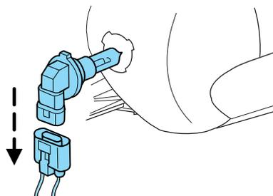
4. Débranchez le connecteur de l'ampoule en le retirant sans le tourner.
