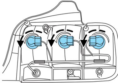
4. Enlevez les trois ensembles d'écrous et de rondelles ainsi que le bloc optique du véhicule.
