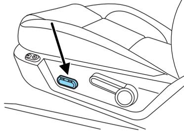
Déplacez la commande dans le sens des flèches pour augmenter ou abaisser la partie avant du coussin de siège.
