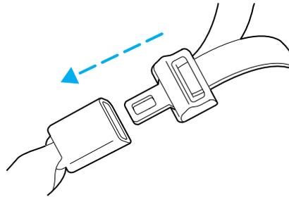
2. Pour déboucler la ceinture, appuyez sur le bouton de déblocage et retirez la languette de la boucle.
