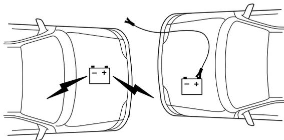
1. Branchez le câble volant positif (+) à la borne positive (+) de la batterie déchargée.
