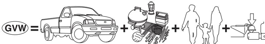
**PTR (poids total roulant)** – Il s'agit du poids à vide en ordre de marche du véhicule additionné de sa charge et de ses occupants.
