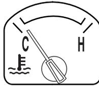
Si le moteur atteint une température prédéterminée, il passe automatiquement à un mode de fonctionnement avec alternance des cylindres. Chaque cylindre inopérant agit alors comme une pompe à air et refroidit le moteur.
