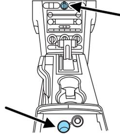
Afin d'empêcher que le fusible ne grille, n'utilisez pas les prises de courant au-delà de la capacité du véhicule de 12 V c.c./180 W/15 A.
