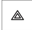
Enfoncez la commande des feux de détresse pour activer tous les feux de détresse avant et arrière. Enfoncez-la de nouveau pour les désactiver. Utilisez cette commande lorsque votre véhicule est en panne et qu'il est immobilisé dans un endroit présentant des risques pour les autres automobilistes.
