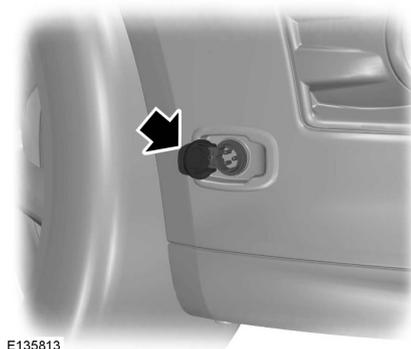
Die Motorvorwärmung muss zwei bis drei Stunden vor dem Motorstart angeschlossen werden.
